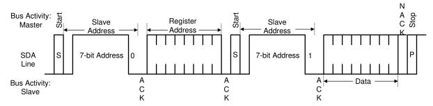
图 7-21. Serial Control Bus — READ
