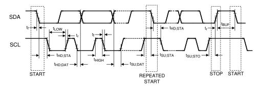
图 6-4. I2C Serial Control Bus Timing
