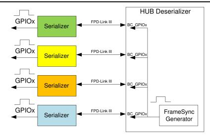
图 7-14. Internal FrameSync
