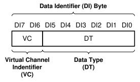
图 7-10. CSI-2 Data Identifier Structure
