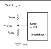
图 7-2. Strap Pin Connection Diagram
