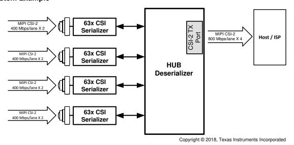
图 8-12. Four DS90UB63x CSI-2 Serialzier Sensor Data Onto CSI-2
