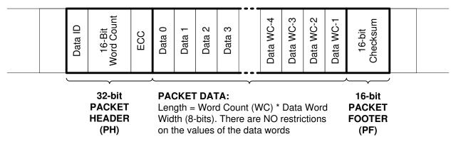
图 7-9. CSI-2 Long Packet Structure
