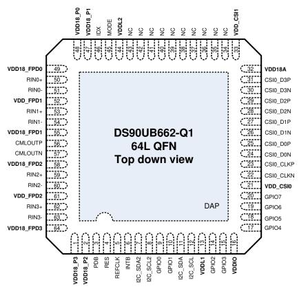
图 5-1. RTD Package 64-Pin VQFN (Top View)
