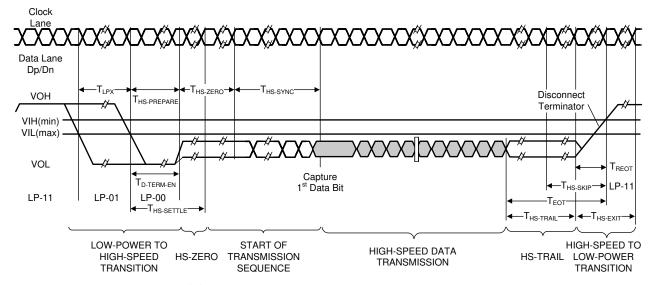
图 6-6. High Speed Data Transmission Burst
