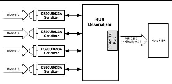
图 8-13. Four DS90UB633A-Q1 Sensor Data Onto CSI-2
