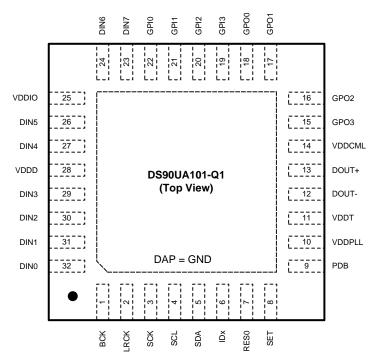
Figure 3. DS90UA101-Q1 — Top View
