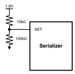
Figure 15. SET Pin configuration on DS90UA101-Q1
