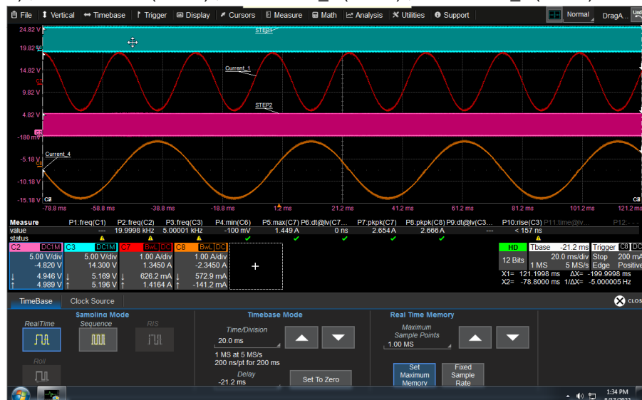
图 9-2. 驱动两个步进电机的 DRV8849
