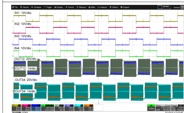
图 8-7. 步进电机全步运行
