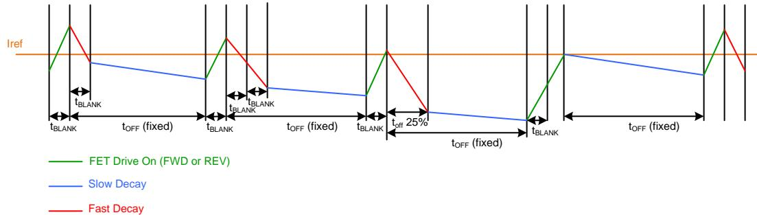
**Figure 11. AutoTune – Mixed Decay Operation**
