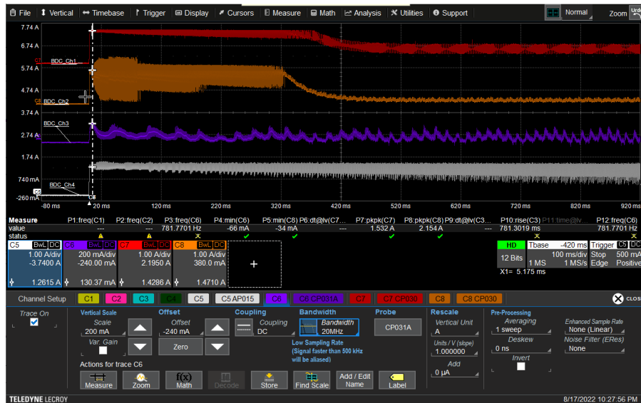
图 8-3. 驱动四个有刷直流电机
