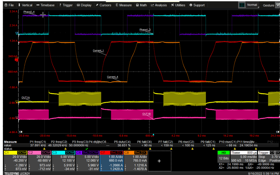
图 8-2. 以全步进模式驱动两个步进电机
