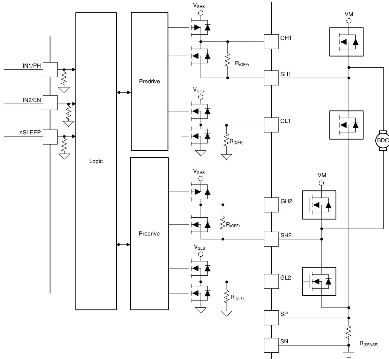
**图 7-9. Predrive Block Diagram**
