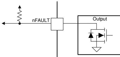
图 7-5. nFAULT Block Diagram
