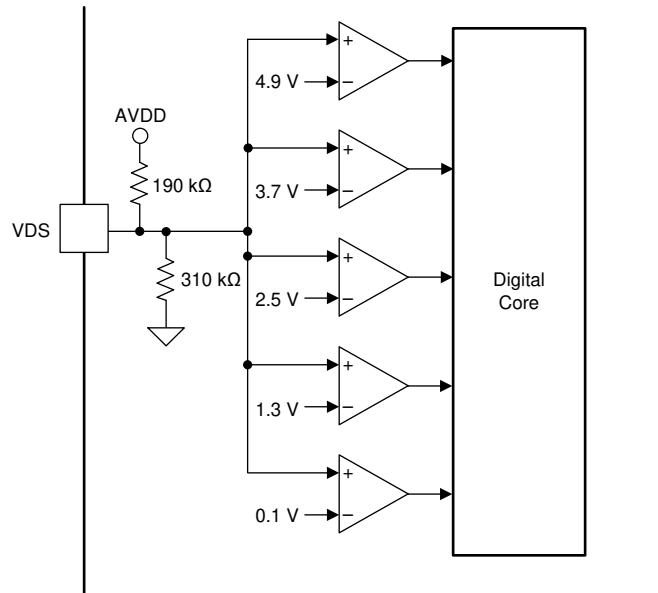
图 7-14. VDS Block Diagram
