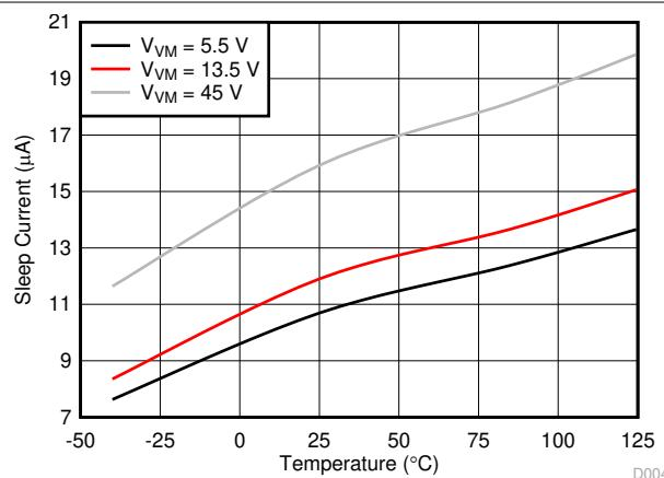
图 6-4. Sleep Current vs Temperature
