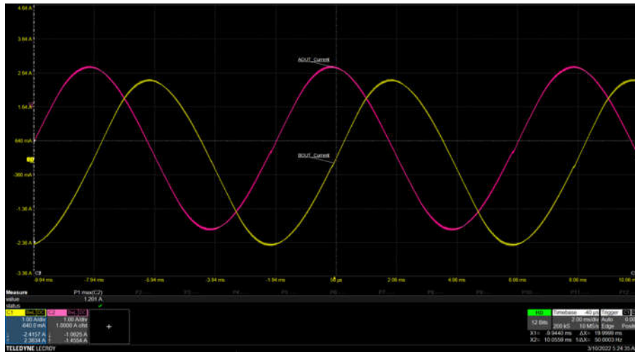
图 7-21. 静音步进衰减模式下的线圈电流波形
