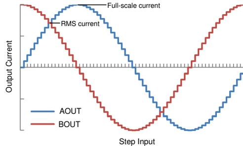
图 7-3. 满量程和均方根电流
