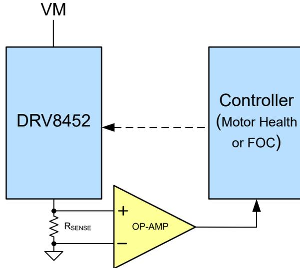
图 7-17. 使用外部电阻器进行电流检测
