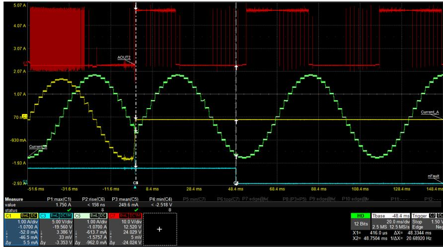
图 7-45. 线圈 A 开路负载检测
