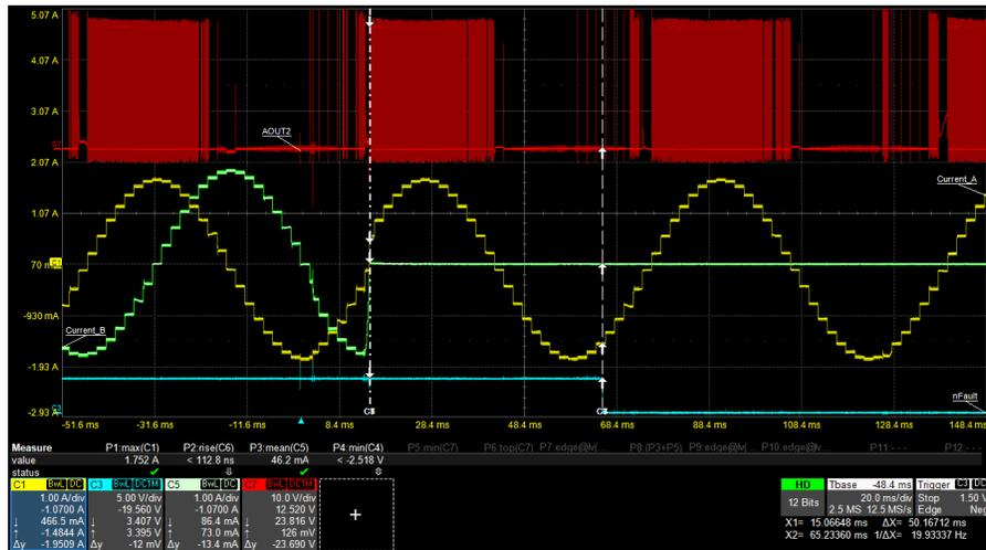
图 7-46. 线圈 B 开路负载检测
