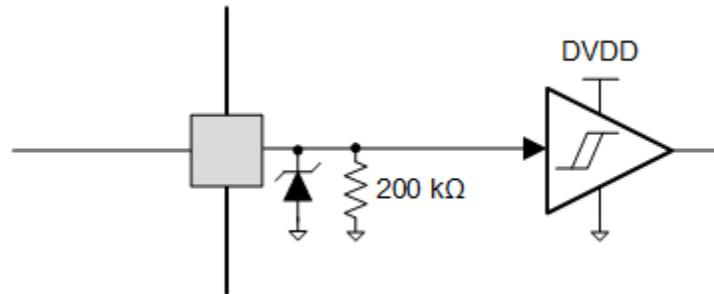
图 7-35. 逻辑电平输入引脚图
