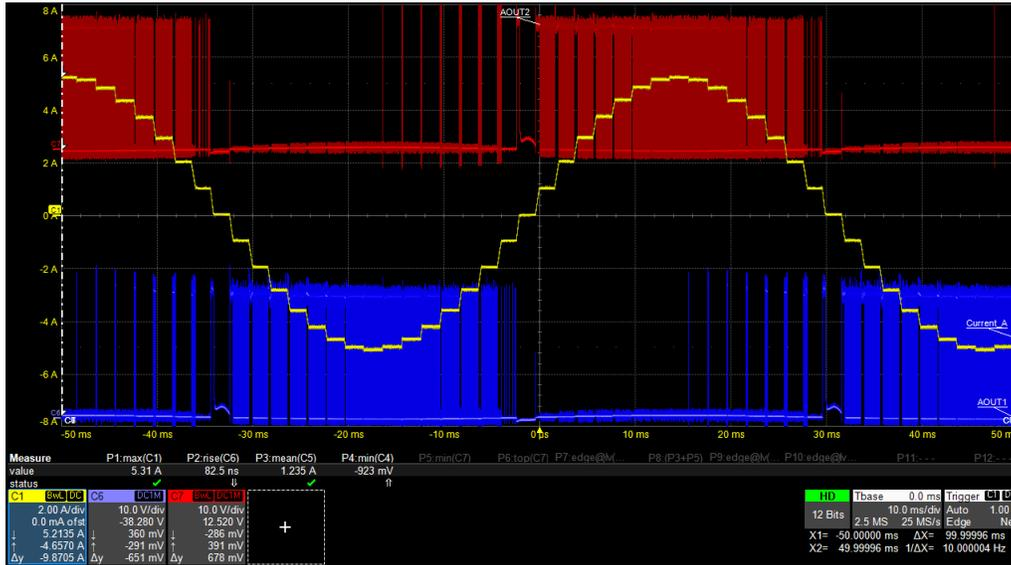
图 7-11. 通过内部基准电压进行电流调节
