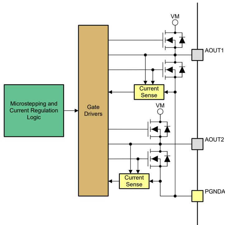
图 7-4. PWM 电机驱动器方框图
