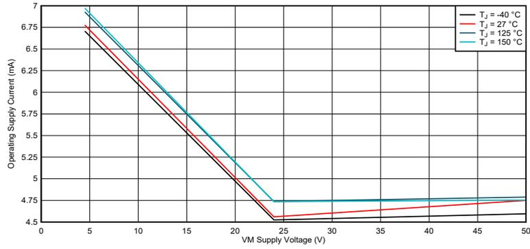
图 6-3. 工作电源电流, VCC = 外部 5V
