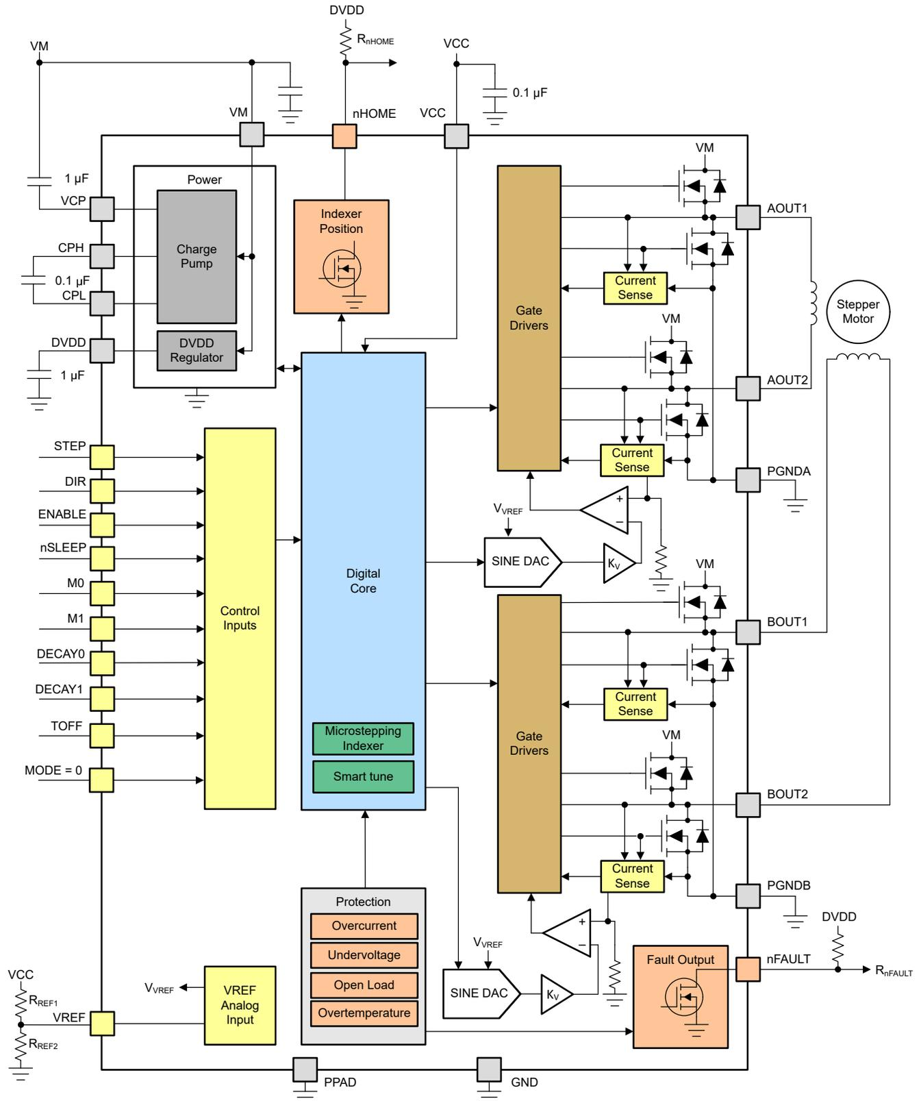
图 7-2. 具有 H/W 接口的 DRV8452 方框图
