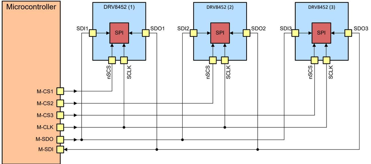
图 7-56. 以并行配置连接三个器件
