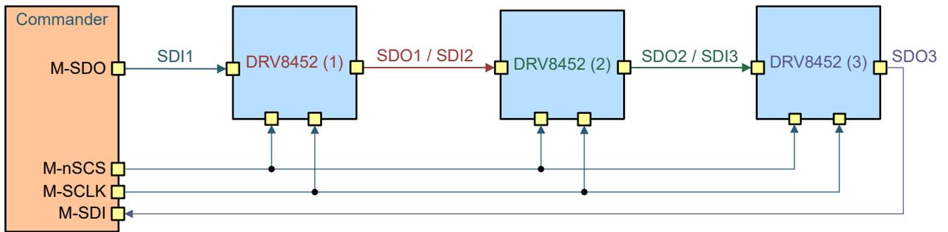
图 7-50. 在菊花链中连接的两个器件
