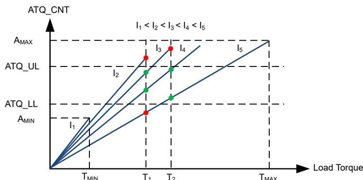
图 7-27. ATQ\_CNT 作为负载转矩的函数
