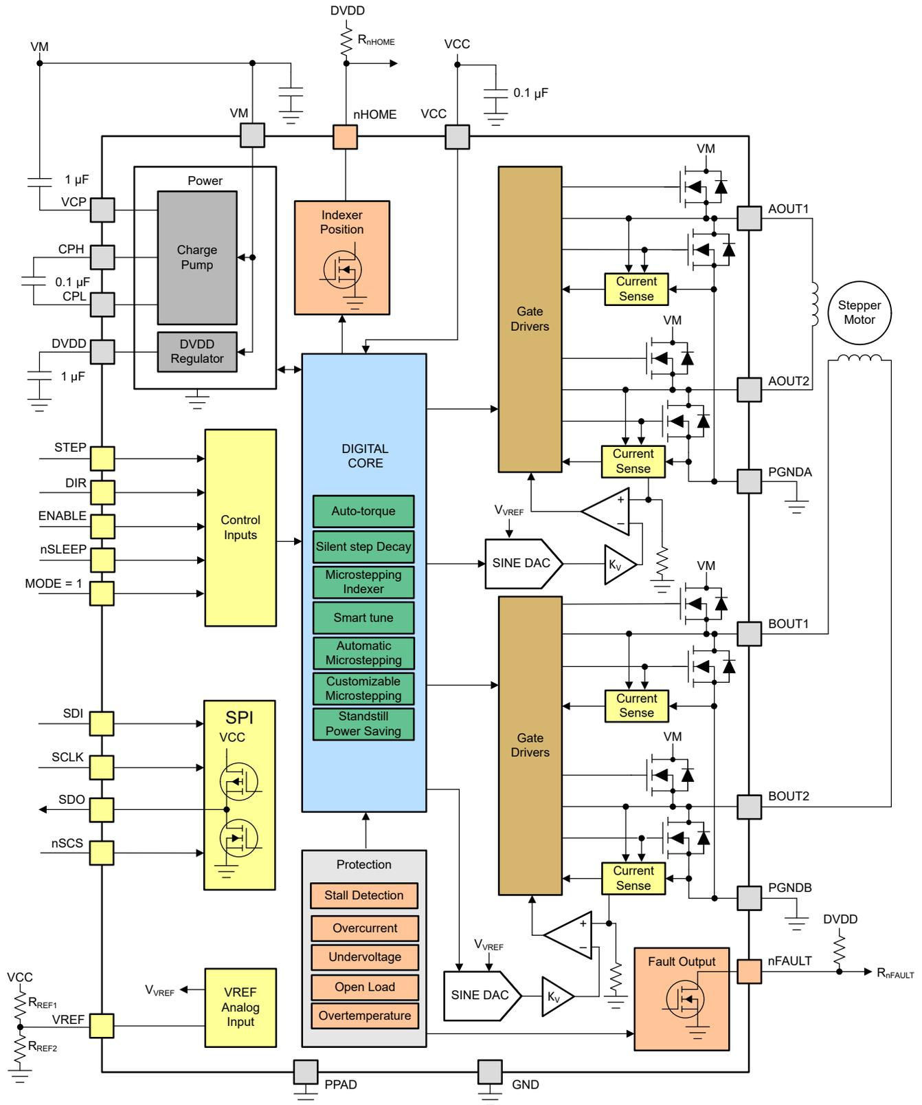
图 7-1. 具有 SPI 接口的 DRV8452 方框图
