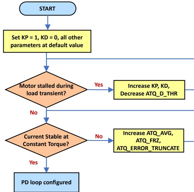
图 7-29. 选择 PD 控制环路参数
