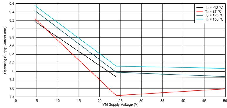
图 6-4. 工作电源电流, VCC = DVDD
