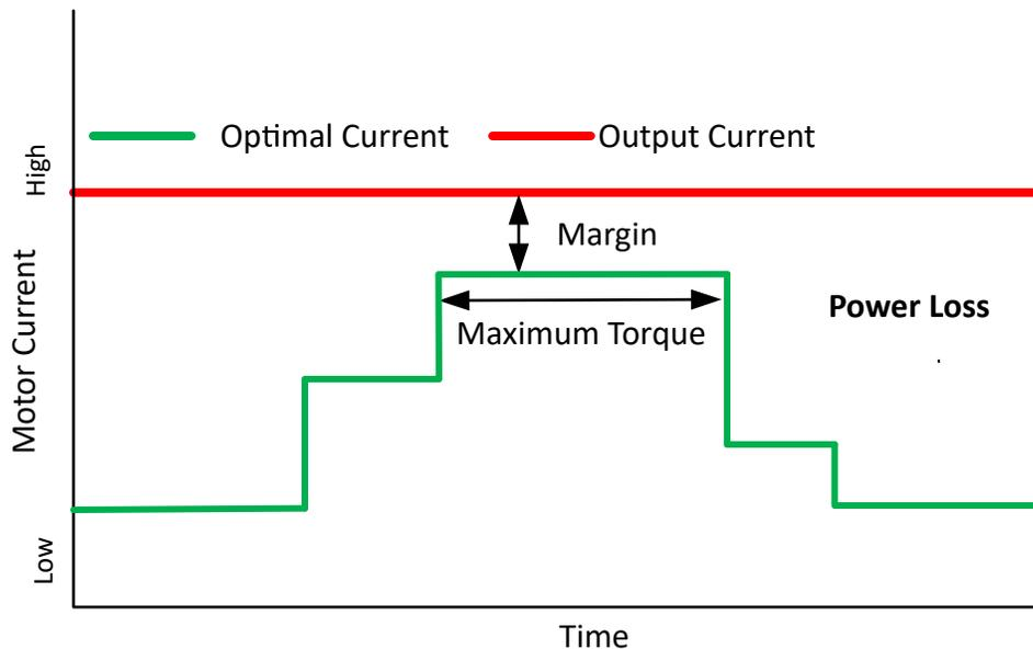
图 7-22. 传统步进电机驱动器的功率损耗
