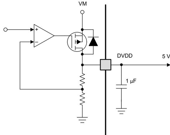
图 7-32. 线性稳压器方框图
