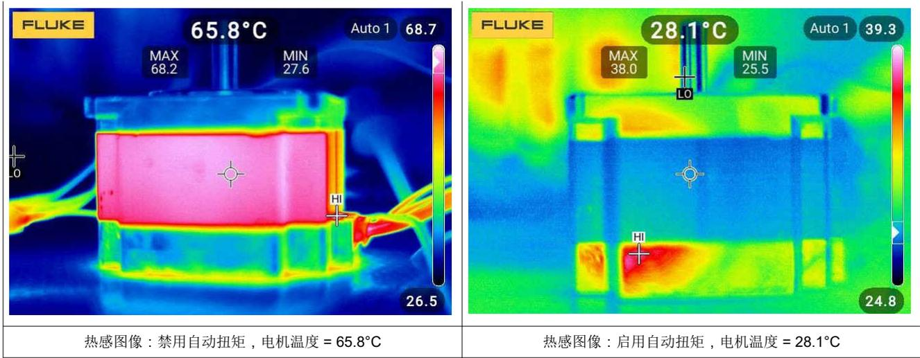
自动扭矩带来的 IC 和电机温度降低可提高步进电机系统的长期可靠性。
