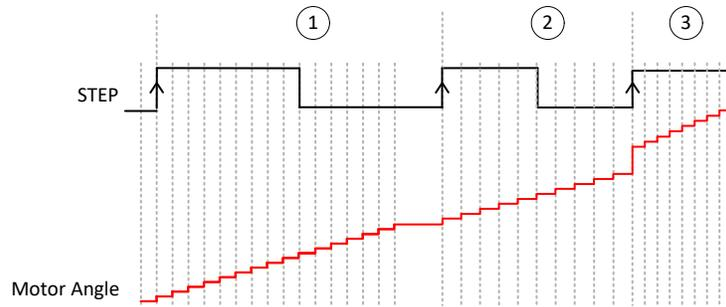
图 7-8. STEP 频率变化时的自动微步进
