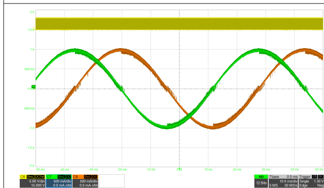
图 8-7. 智能调优纹波控制衰减下的 1/256 微步进
