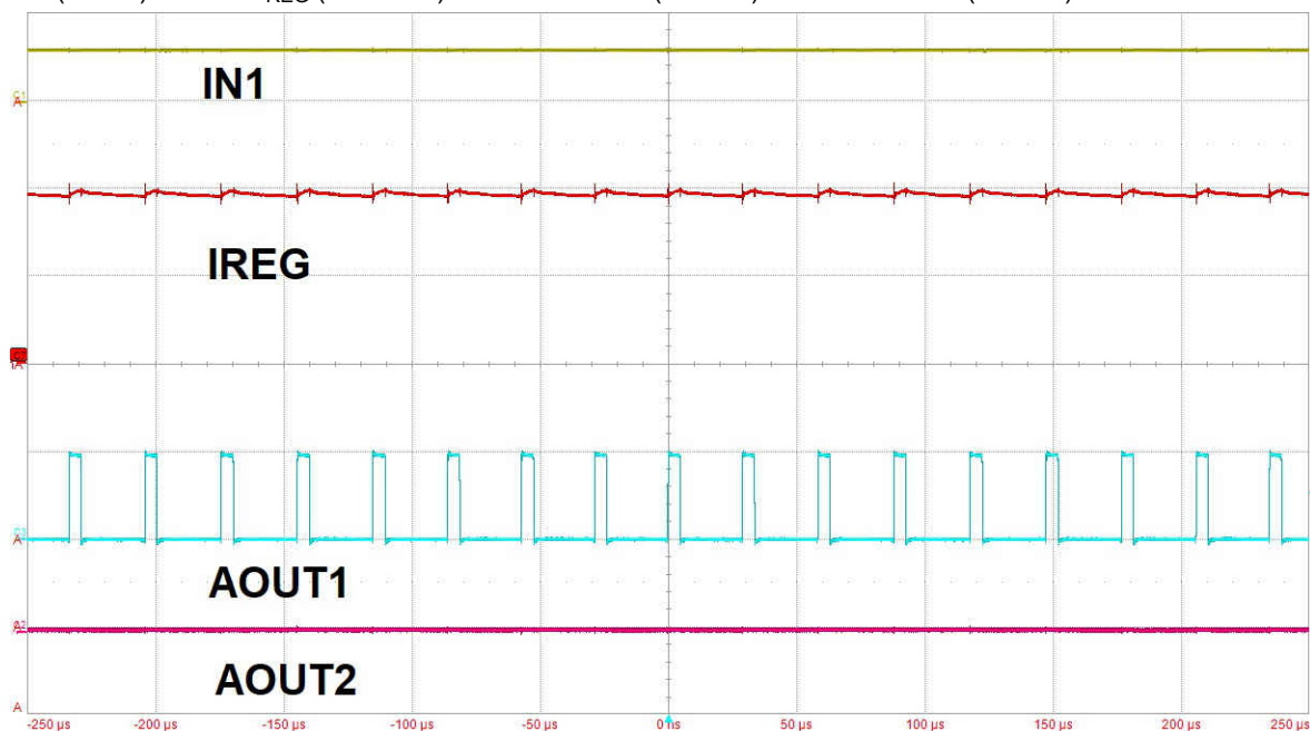
图 8-4. 在进行电流调节的情况下，驱动器全开运行
