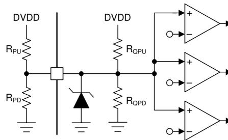
图 7-15. 四电平输入结构 (GAIN)
