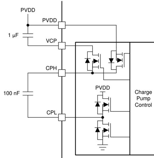
图 7-6. 电荷泵架构
