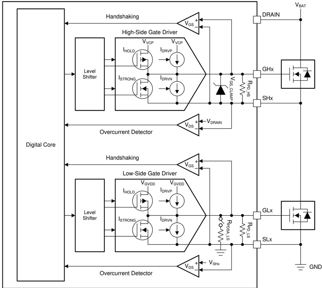
图 7-4. 栅极驱动器功能方框图
