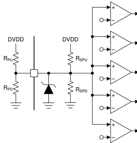
图 7-16. 六电平输入结构 (IDRIVE, VDS)
