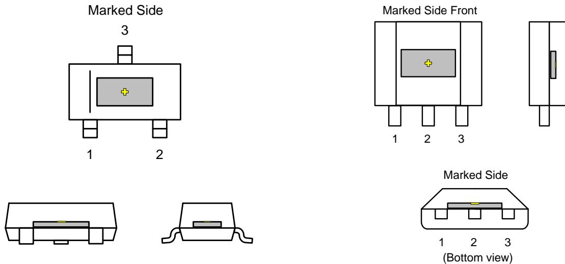
图 25. SOT-23 (DBZ) 封装
