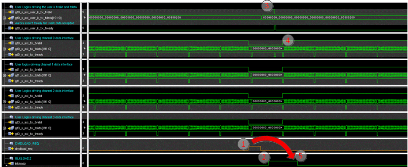
图 7-5. 块 DMDLOAD_REQ 置为有效结束后跟新块控制字的波形
