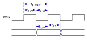
图 6-8. Parallel Interface Pixel Timing
