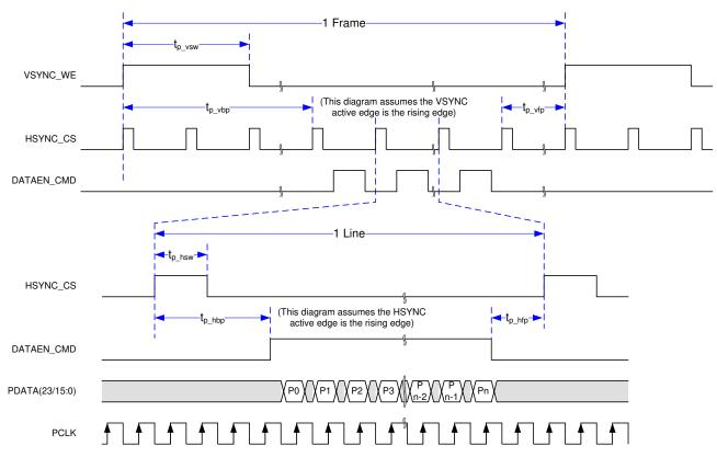
图 6-7. Parallel Interface Frame Timing
