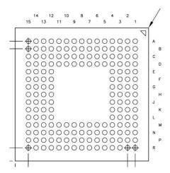
图 5-1. ZVB Package 176-Pin NFBGA Bottom View
