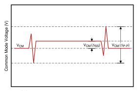
图 6-1. Common Mode Voltage
