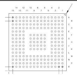
图 5-2. ZEZ Package 201-Pin NFBGA Bottom View
