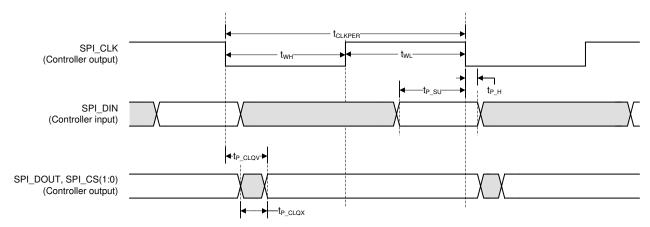
图 6-10. Flash Interface Timing
