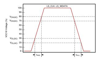
图 6-4. LS\_CLK and LS\_WDATA Slew Rate
