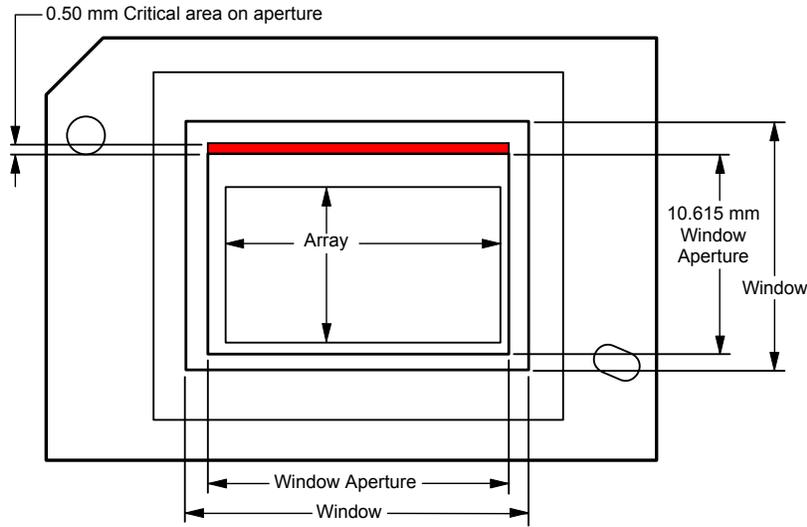
图 5-2. 照明溢出图 — 关键区域
