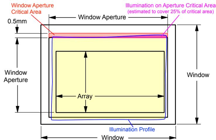
图 6-2. 照明溢出图 — 关键区域
