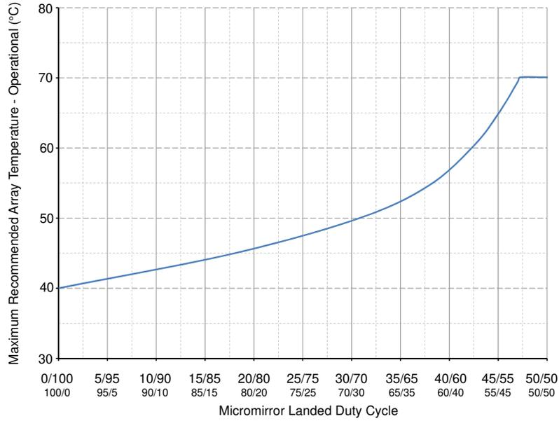
图 5-1. 最大建议阵列温度 — 降额曲线
