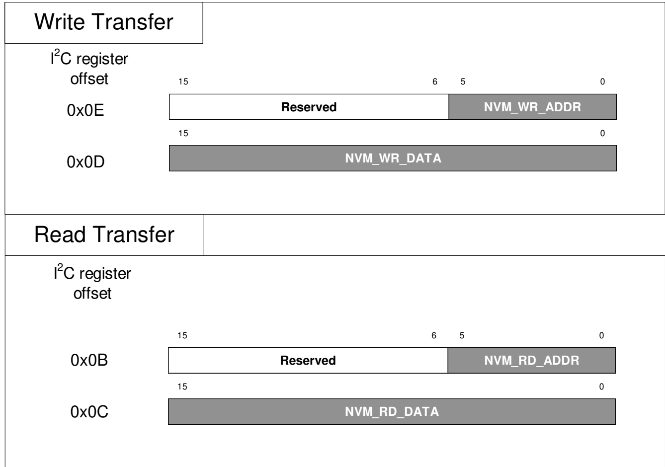
图 10-11. 使用 I 2 C 的 EEPROM 直接访问
