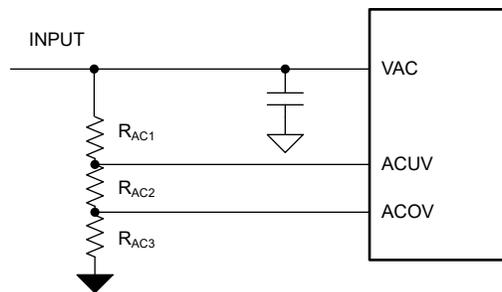
图 8-2. ACUV 和 ACOV 电阻分压器
