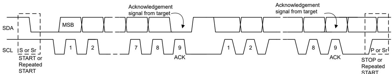
图 7-9. I<sup>2</sup>C 总线上的数据传输
