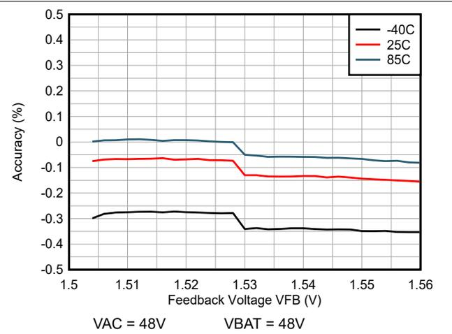
图 6-4. 反馈电压精度 (在不同的温度下)
