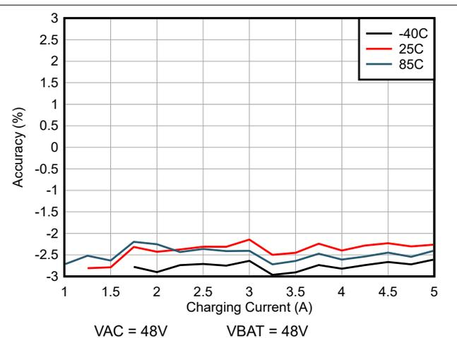
图 6-6. 充电电流精度 (在不同的温度下)
