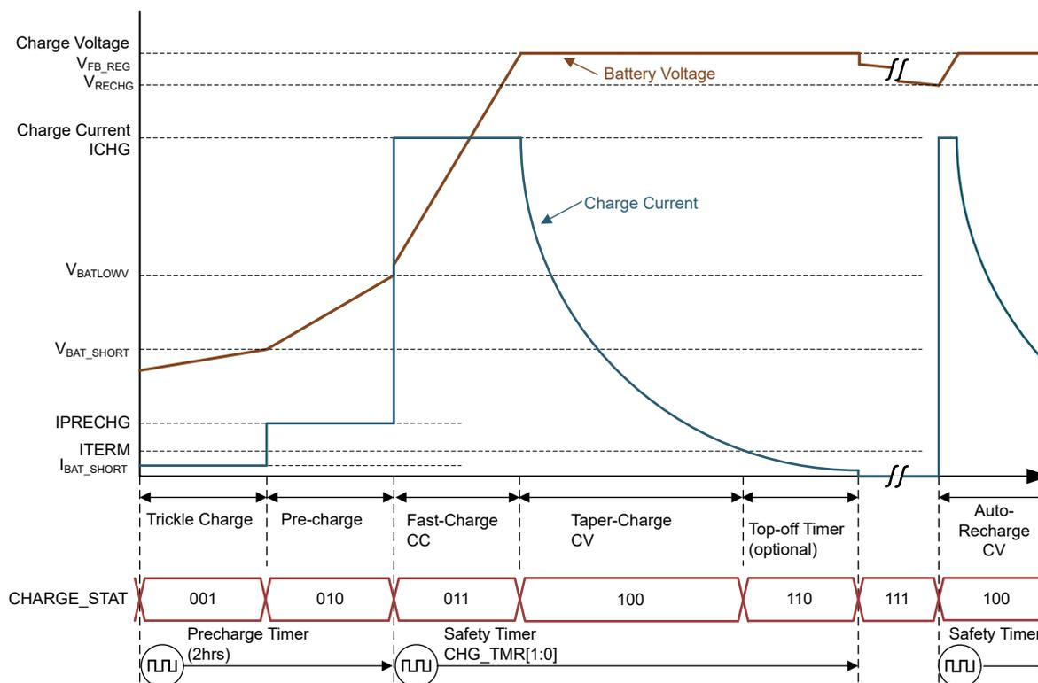
图 7-3. 典型的锂离子电池充电曲线
