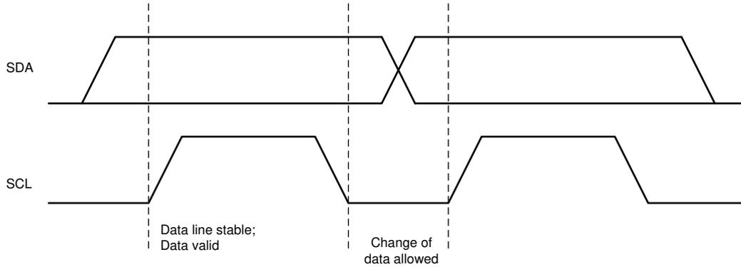
图 7-7. I<sup>2</sup>C 总线上的位传输
