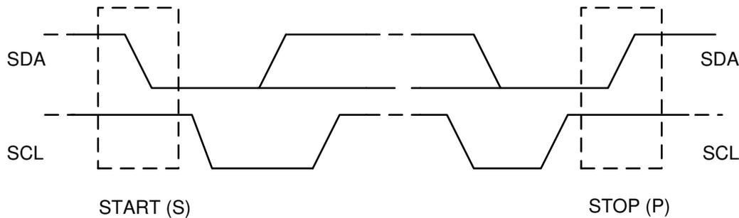
图 7-8. I<sup>2</sup>C 总线上的 START 和 STOP 条件
