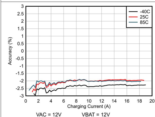
图 6-5. 充电电流精度 (在不同的温度下)
