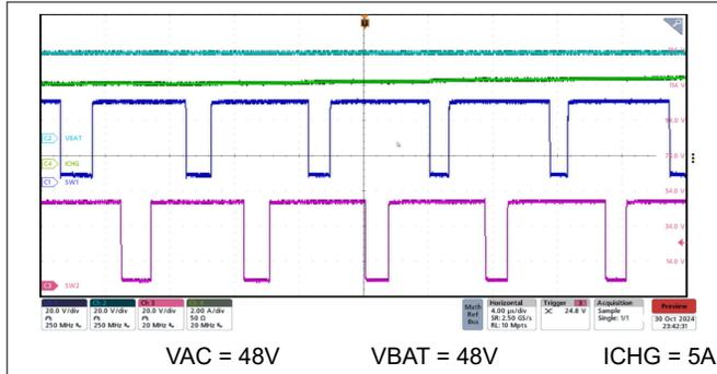
图 8-9. 降压/升压开关波形
