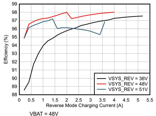
图 6-12. 反向模式效率 (12 节锂离子电池配置)
