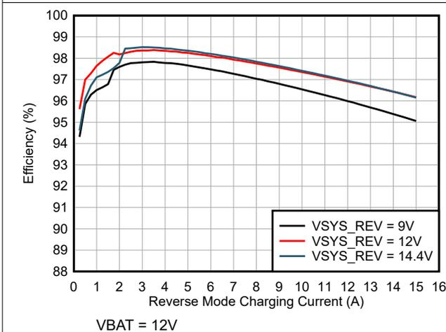
图 6-11. 反向模式效率 (4 节磷酸铁锂电池配置)
