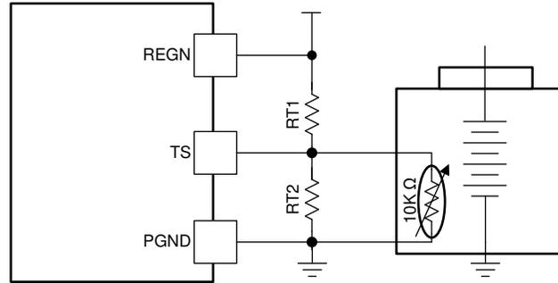
假设电池包上有一个 103AT NTC 热敏电阻（如上图所示），RT1 和 RT2 的值可以通过以下公式确定：
