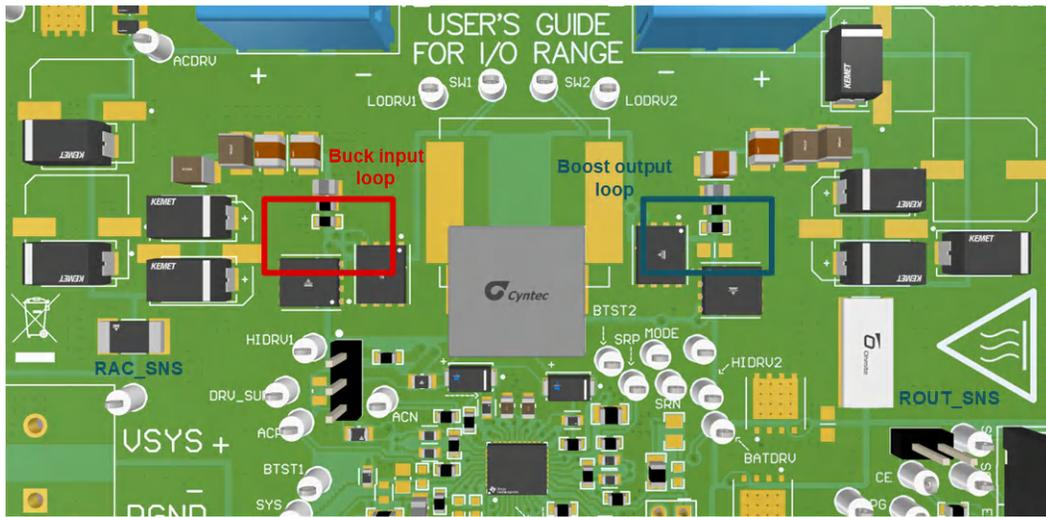
图 10-1. PCB 布局参考示例顶视图
