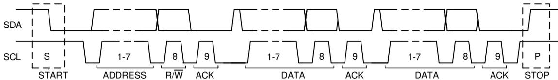
图 7-10. I<sup>2</sup>C 总线上的完整数据传输
