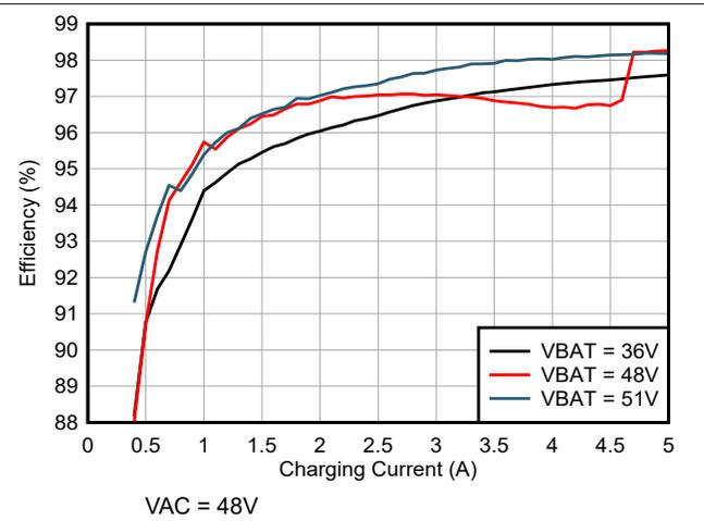
图 6-2. 充电效率与充电电流间的关系
