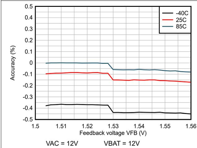
图 6-3. 反馈电压精度 (在不同的温度下)
