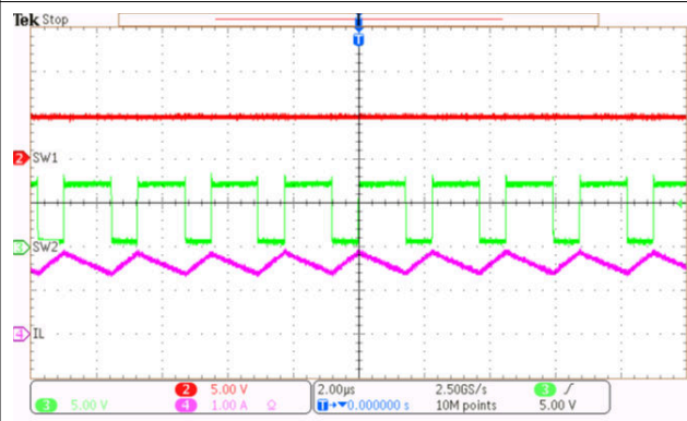
图 7-11. 正向降压模式 CCM
