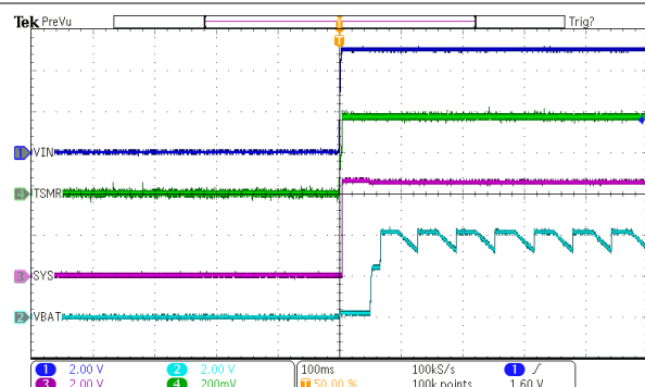
图 8-2. 在没有电池的情况下通过插入 IN 电源进行上电
