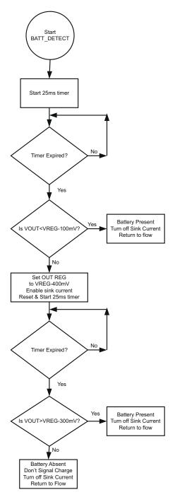
图 8-7. Battery Detect Routine (BQ24040)
