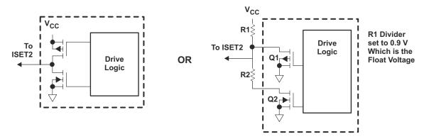
图 8-6. 3-State ISET2 Terminal Circuits
