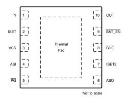
图 6-2. BQ24041 DSQ Package 10-Pin WSON Top View
