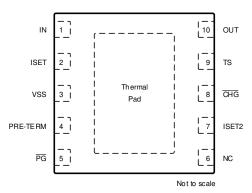
图 6-1. BQ24040 and BQ24045 DSQ Package 10-Pin WSON Top View
