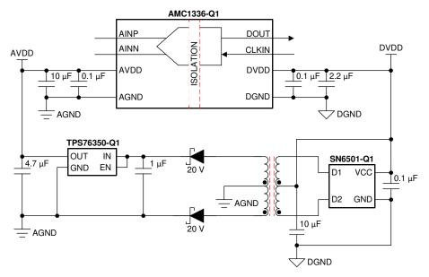
Figure 54. Decoupling the AMC1336-Q1
