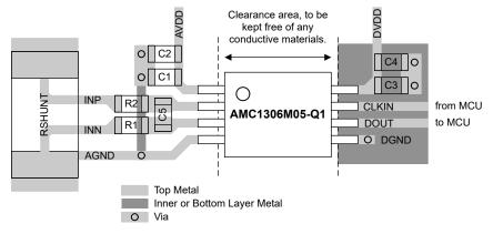
图 10-1. Recommended Layout of the AMC1306M05-Q1
