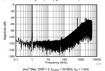
图 7-1. Quantization Noise Shaping
