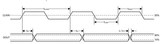
图 6-1. Digital Interface Timing
