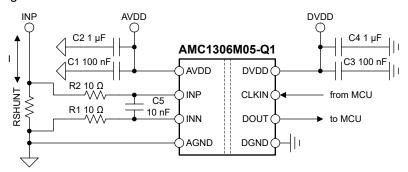
图 9-1. Decoupling of the AMC1306M05-Q1
