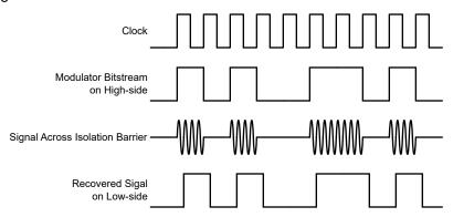
图 7-3. OOK-Based Modulation Scheme
