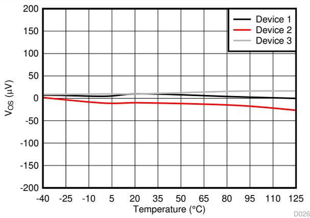
图 6-9. Input Offset Voltage vs Temperature
