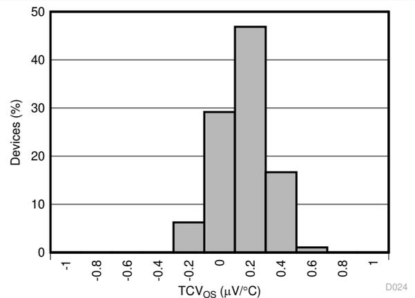
图 6-10. Input Offset Drift Histogram
