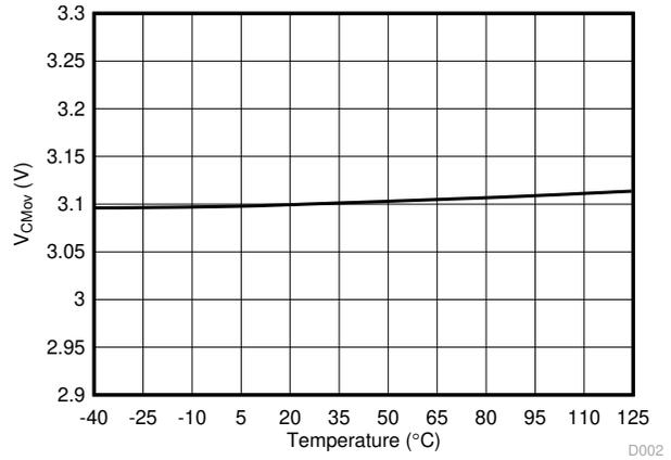
图 6-6. Common-Mode Overvoltage Detection Level vs Temperature
