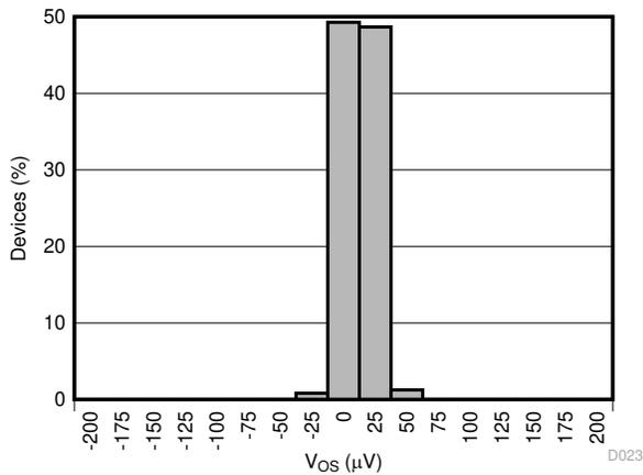
图 6-7. Input Offset Voltage Histogram
