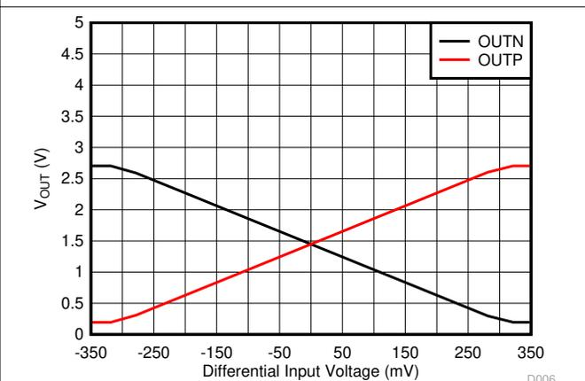
图 6-22. Output Voltage vs Input Voltage
