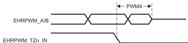
图 6-47. EHRPWM\_TZn\_IN 至 EHRPWM\_A/B 高阻态开关特性
