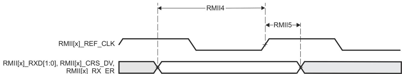
图 6-31. CPSW3G RMII[x]\_RXD[1:0]、RMII[x]\_CRS\_DV、RMII[x]\_RX\_ER 时序要求 - RMII 模式
