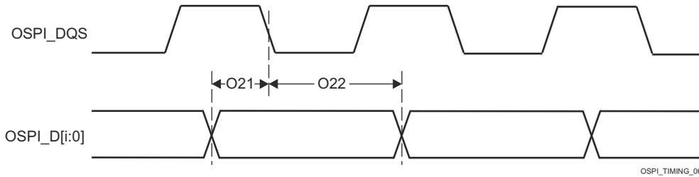
图 6-98. OSPI0 时序要求 - 具有外部电路板环回的 PHY SDR
