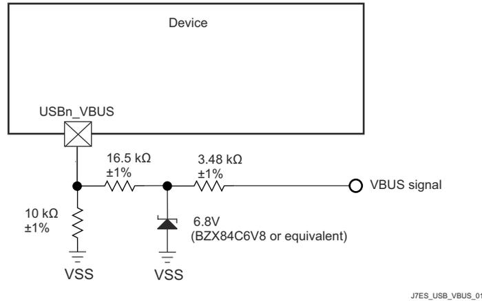
图 8-4. USB VBUS 检测分压器/钳位电路
