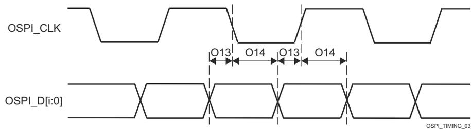
**图 6-104. OSPI0 时序要求 - Tap DDR，无环回**
