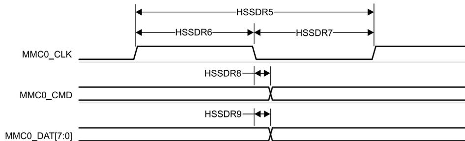
图 6-73. MMC0 - 高速 SDR 模式 - 发送模式
