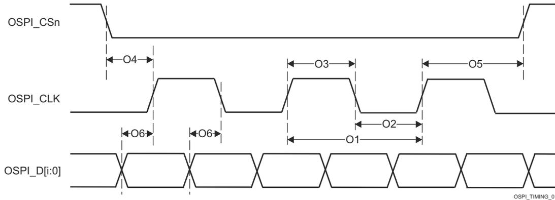
图 6-105. OSPI0 开关特性 - Tap DDR, 无环回
