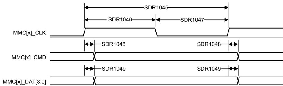
图 6-96. MMC1/MMC2 - UHS-I SDR104 - 发送模式
