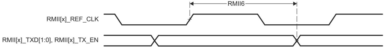
图 6-32. RMII[x]\_TXD[1:0] 和 RMII[x]\_TX\_EN 开关特性 - RMII 模式
