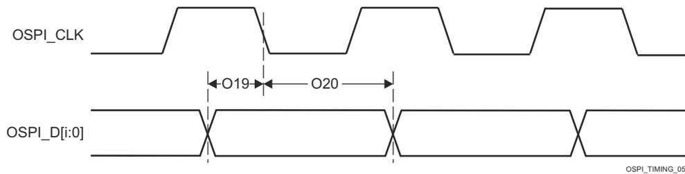
图 6-102. OSPI0 时序要求 - Tap SDR，无环回
