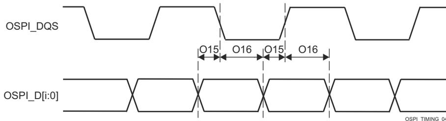
图 6-100. OSPI0 时序要求 - 具有外部电路板环回或 DQS 的 PHY DDR
