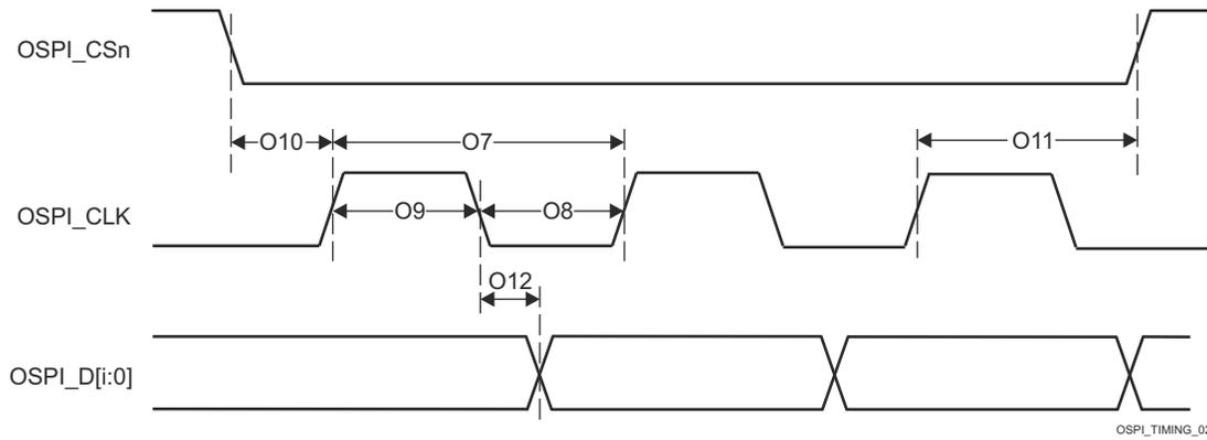
图 6-103. OSPI0 开关特性 - Tap SDR, 无环回
