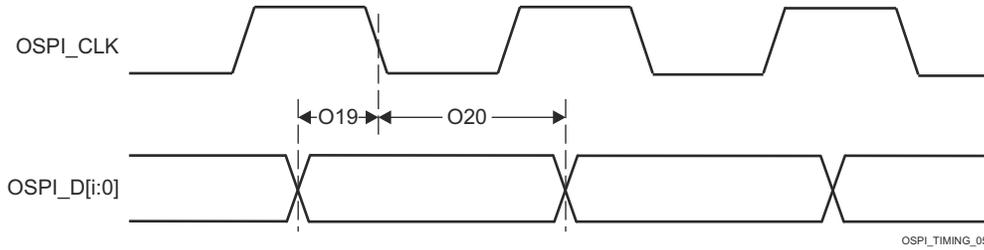
图 6-97. OSPI0 时序要求 - 具有内部 PHY 环回的 PHY SDR
