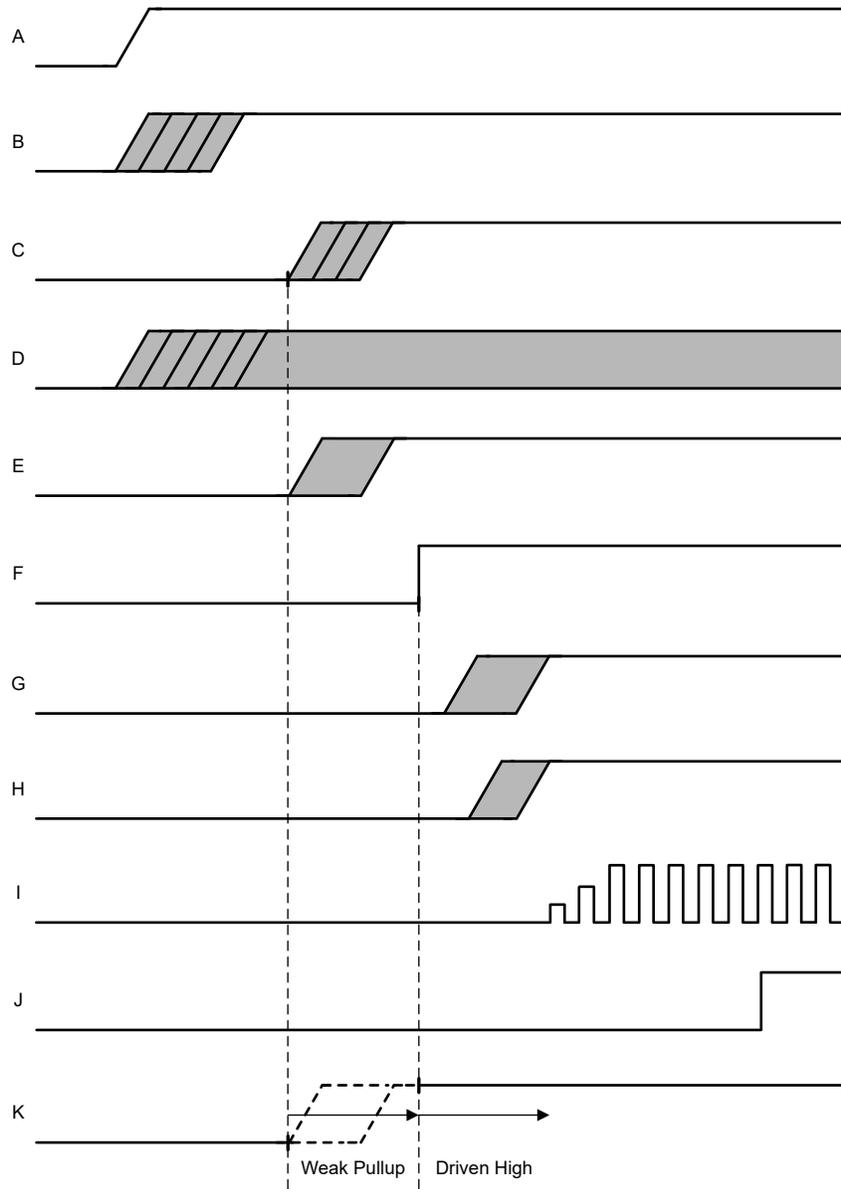
图 6-10. RTC + IO + DDR 低功耗模式上电时序
