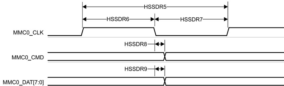
图 6-66. MMC0 - 高速 SDR 模式 - 发送模式
