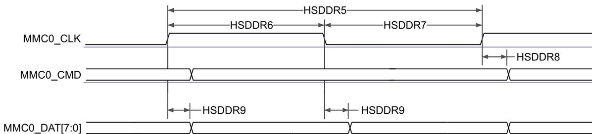
图 6-68. MMC0 - 高速 DDR 模式 - 发送模式
