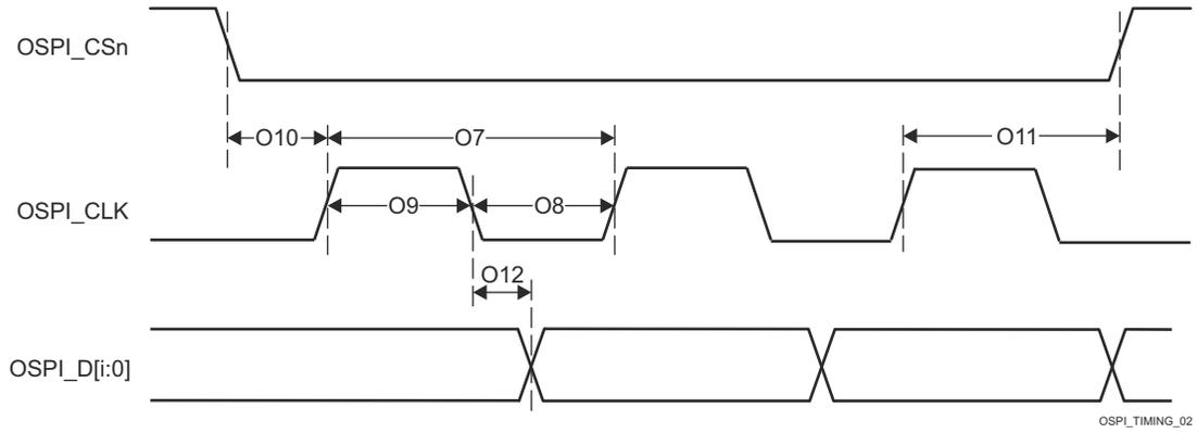
图 6-95. OSPI0 开关特性 - PHY SDR 数据训练
