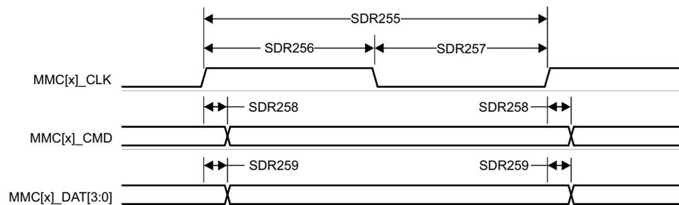
**图 6-88. MMC1/MMC2 - UHS-I SDR25 - 发送模式**
