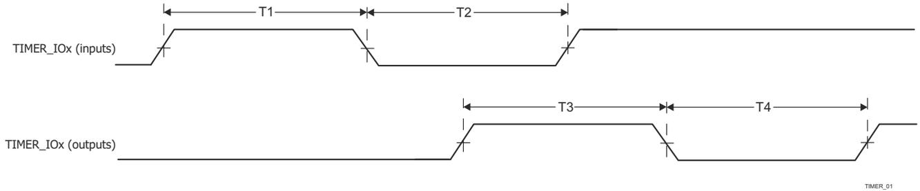
图 6-105. 计时器时序要求和开关特性
