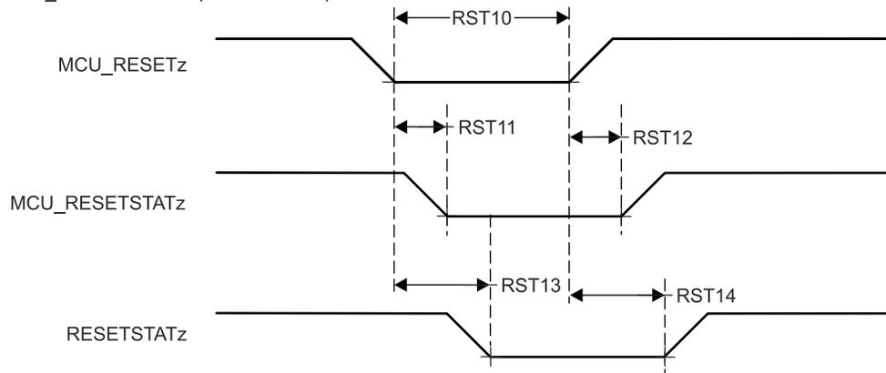
图 6-9. MCU\_RESETz、MCU\_RESETSTATz 和 RESETSTATz 时序要求和开关特性
