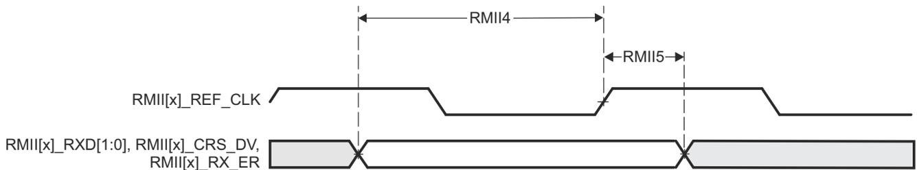
图 6-26. CPSW3G RMII[x]\_RXD[1:0]、RMII[x]\_CRS\_DV、RMII[x]\_RX\_ER 时序要求 - RMII 模式
