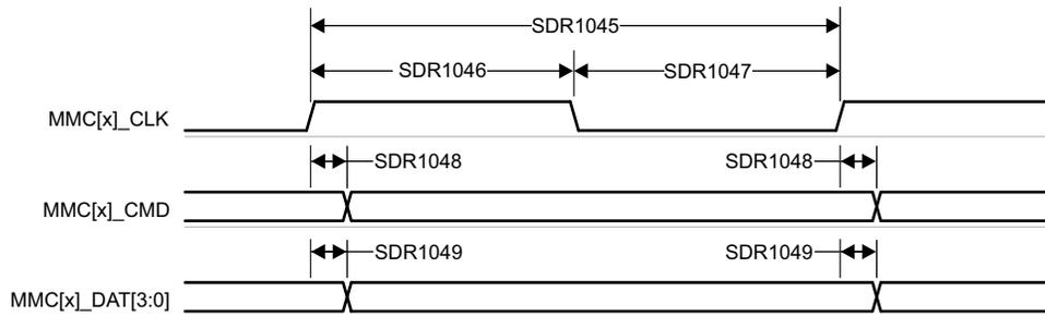
图 6-91. MMC1/MMC2 - UHS-I SDR104 - 发送模式
