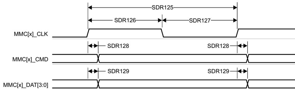
图 6-86. MMC1/MMC2 - UHS-I SDR12 - 发送模式
