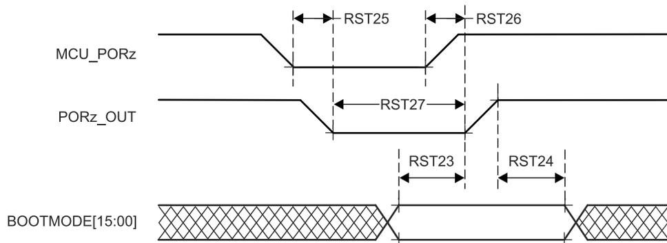
图 6-12. BOOTMODE 时序要求和 PORz\_OUT 开关特性
