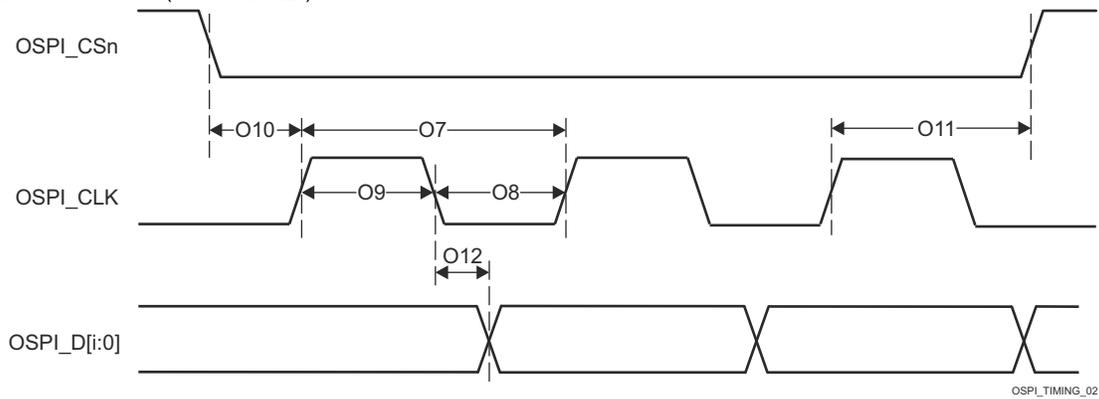
图 6-102. OSPI0 开关特性 - Tap SDR, 无环回
