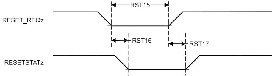
图 6-10. RESET\_REQz 和 RESETSTATz 时序要求和开关特性
