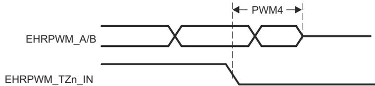
图 6-40. EHRPWM\_TZn\_IN 至 EHRPWM\_A/B 高阻态开关特性
