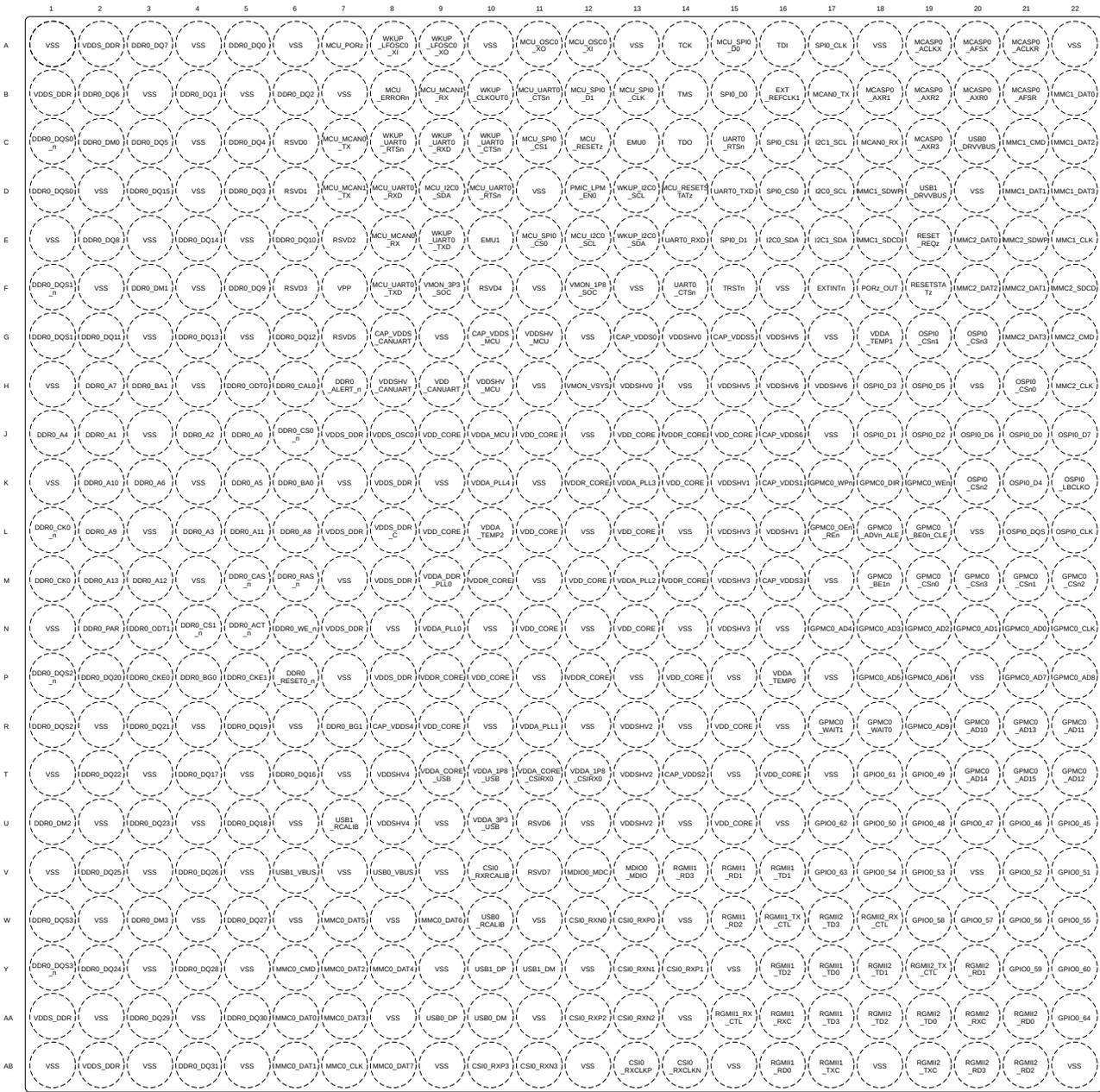
图 5-1. ANF FCCSP BGA 引脚图 (顶视图)
