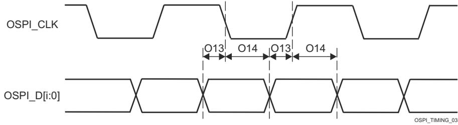
图 6-103. OSPI0 时序要求 - Tap DDR, 无环回
