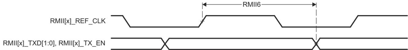
图 6-27. RMII[x]\_TXD[1:0] 和 RMII[x]\_TX\_EN 开关特性 - RMII 模式
