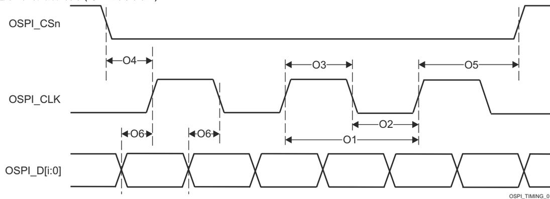
图 6-104. OSPI0 开关特性 - Tap DDR, 无环回
