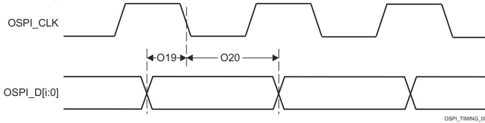
图 6-101. OSPI0 时序要求 - Tap SDR，无环回
