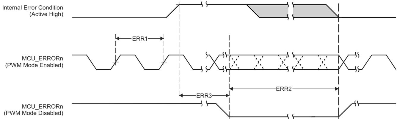
图 6-13. MCU\_ERRORn 时序要求和开关特性
