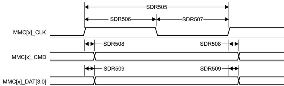
图 6-89. MMC1/MMC2 - UHS-I SDR50 - 发送模式
