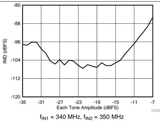
图 30. IMD vs Input Amplitude
