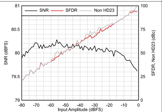
图 6-27. AC Performance vs Input Amplitude
