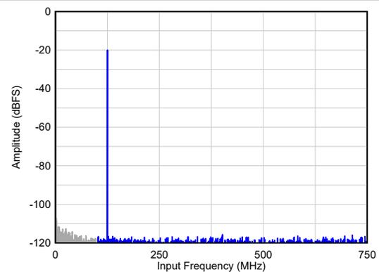
$F_{IN} = 200\text{MHz}$ 、 $A_{IN} = -20\text{dBFS}$ 、 $\text{SNR}_{\text{flat}} = 80.6\text{dBFS}$
