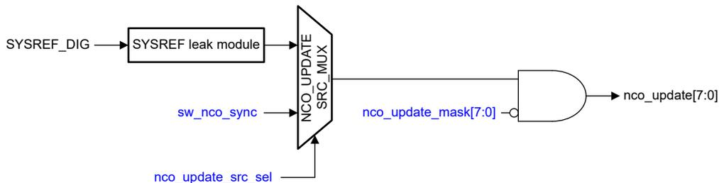
图 7-32. 使用所有控制信号进行 NCO 更新
