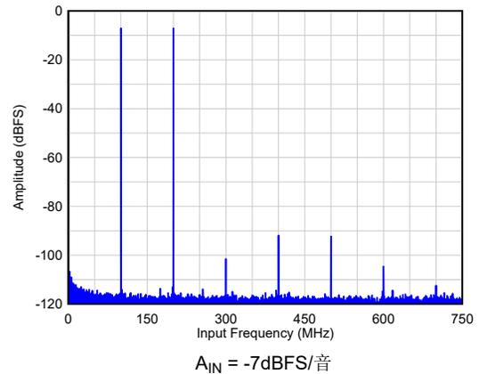
图 5-6.  $F_{IN} = 100\text{MHz}/200\text{MHz}$  时的双音 FFT
