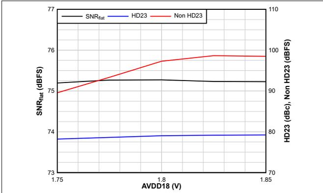
图 5-19. 交流性能与 AVDD18 电源间的关系
