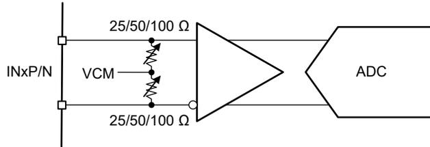
图 7-1. 模拟输入 (内部) 电路
