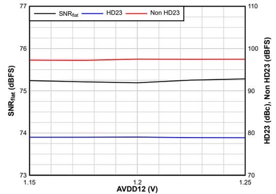
图 5-18. 交流性能与 AVDD12 电源间的关系
