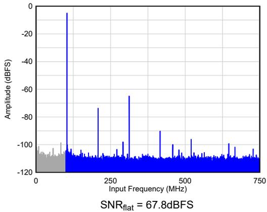
图 5-5.  $F_{IN} = 1400\text{MHz}$  时的单音 FFT
