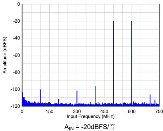
图 5-9.  $F_{IN} = 900\text{MHz}/1000\text{MHz}$  时的双音 FFT
