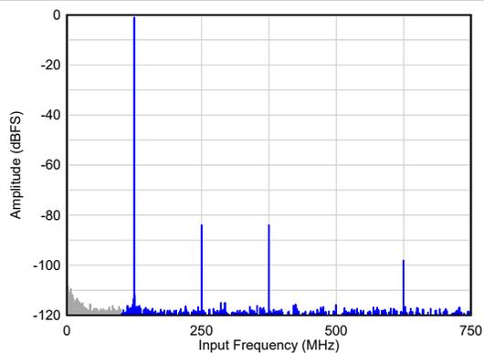
$F_{IN} = 125\text{MHz}$ 、 $A_{IN} = -1\text{dBFS}$ 、 $\text{SNR}_{\text{flat}} = 80.2\text{dBFS}$
