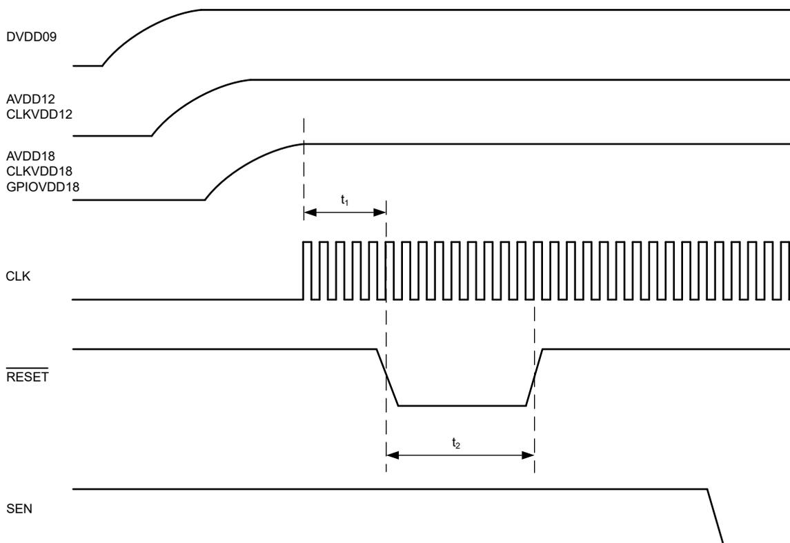
图 8-10. 上电后初始化串行寄存器
