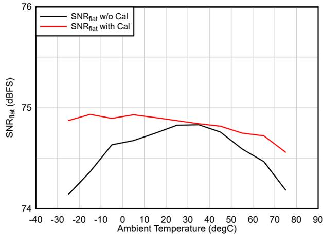
$F_{IN} = 100\text{MHz}$ ,  $A_{IN} = -1\text{dBFS}$ , 在 25°C 下校准
