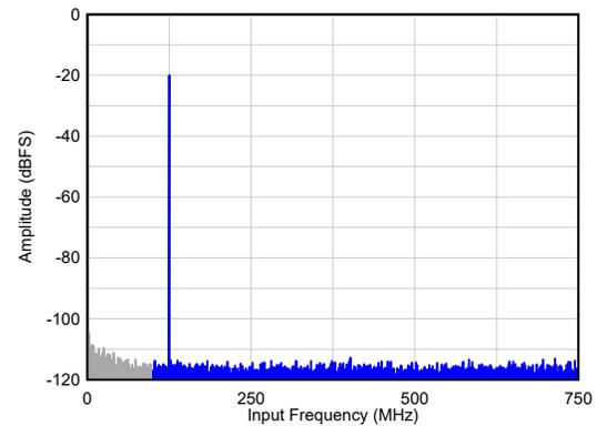
$F_{IN} = 200\text{MHz}$ 、 $A_{IN} = -20\text{dBFS}$ 、 $\text{SNR}_{\text{flat}} = 78.2\text{dBFS}$
