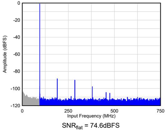
图 5-1.  $F_{IN} = 100\text{MHz}$  时的单音 FFT
