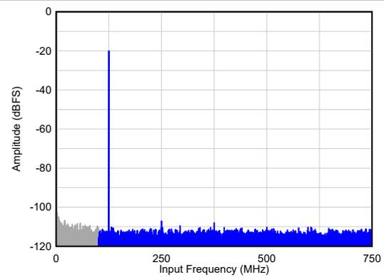
$F_{IN} = 125\text{MHz}$ 、 $A_{IN} = -20\text{dBFS}$ 、 $\text{SNR}_{\text{flat}} = 75.5\text{dBFS}$
