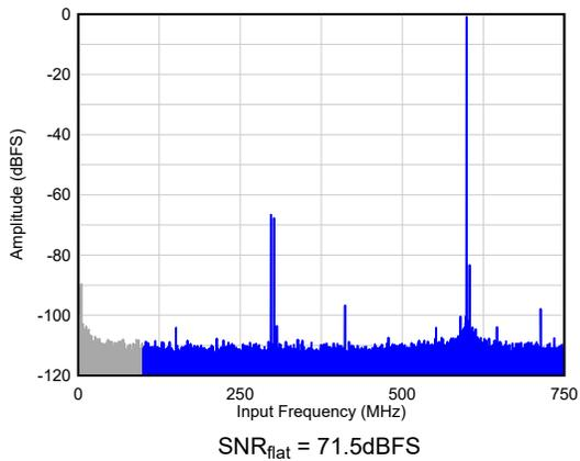
图 5-3.  $F_{IN} = 900\text{MHz}$  时的单音 FFT
