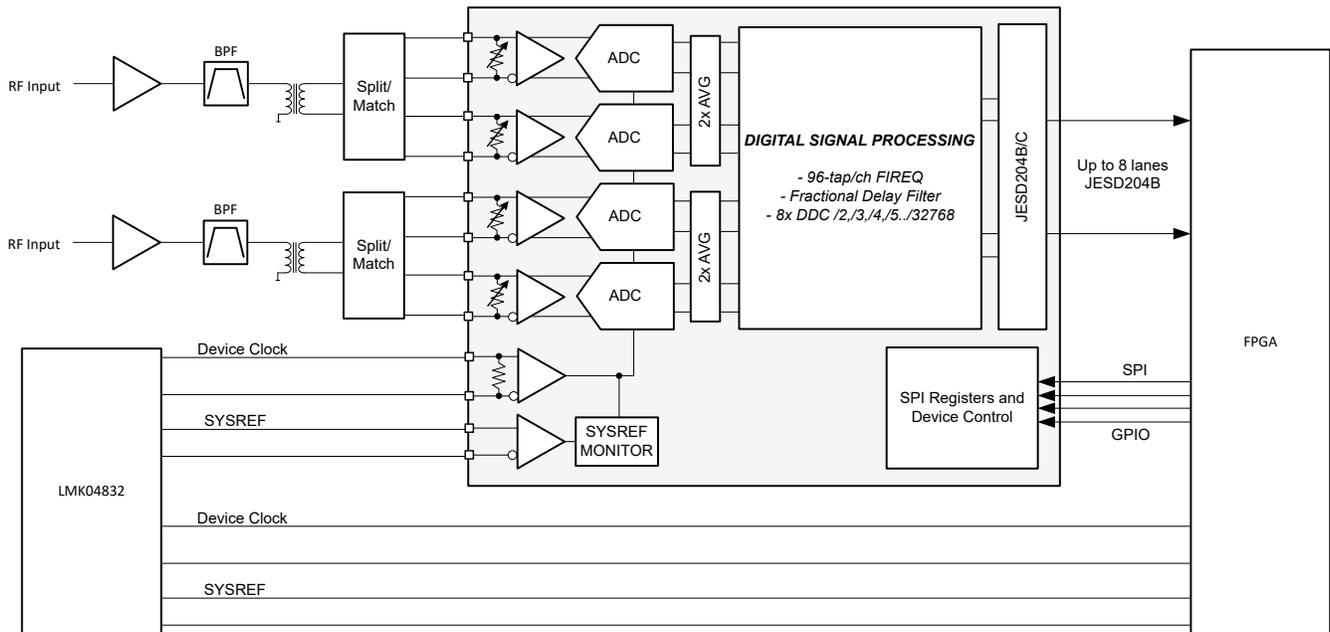
图 8-1. 宽带射频采样接收器
