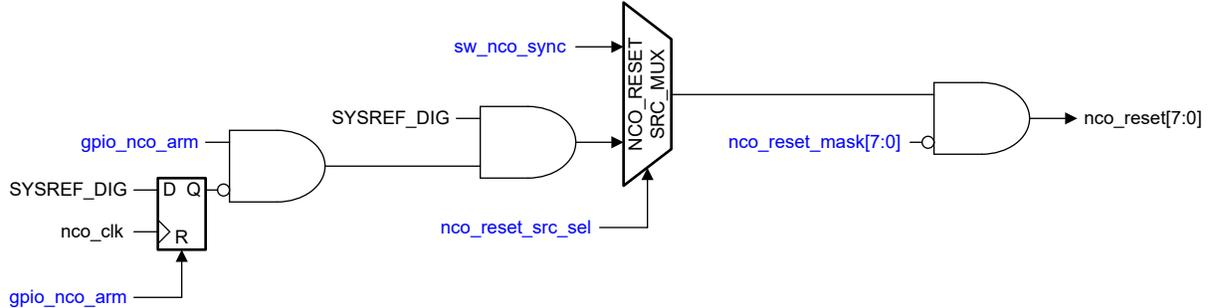
图 7-33. 使用所有控制信号进行 NCO 复位
