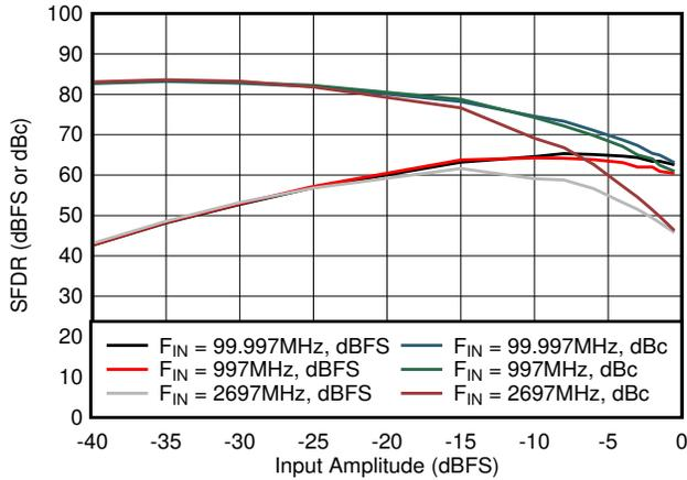
图 5-33. SFDR vs Input Amplitude
