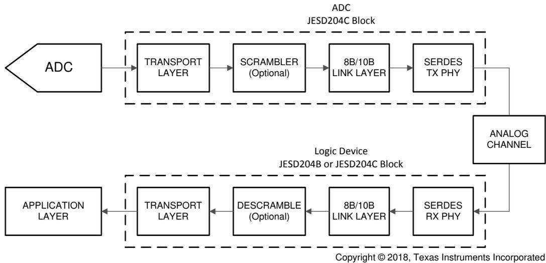
**图 6-7. Simplified 8B/10B Encoded JESD204C Interface Diagram**
