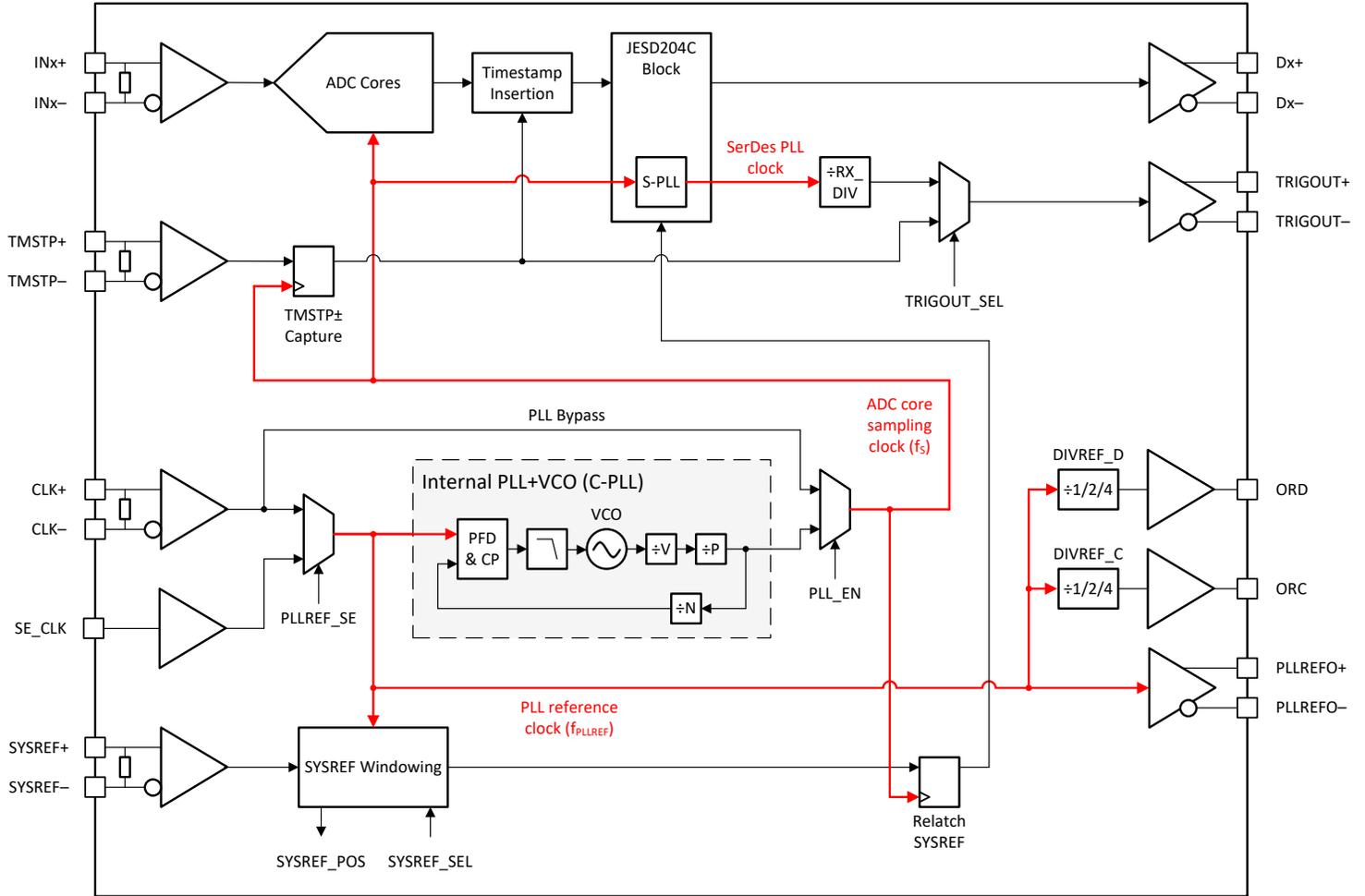
图 6-5. Clocking Subsystem
