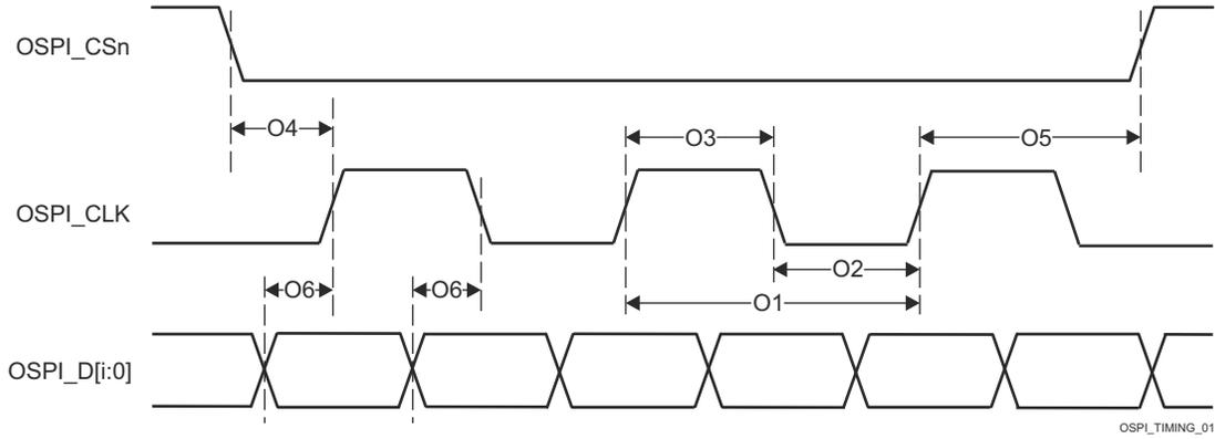
图 6-66. OSPI0 开关特性 - Tap DDR , 无环回
