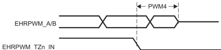
图 6-36. EHRPWM\_TZn\_IN 至 EHRPWM\_A/B 高阻态开关特性
