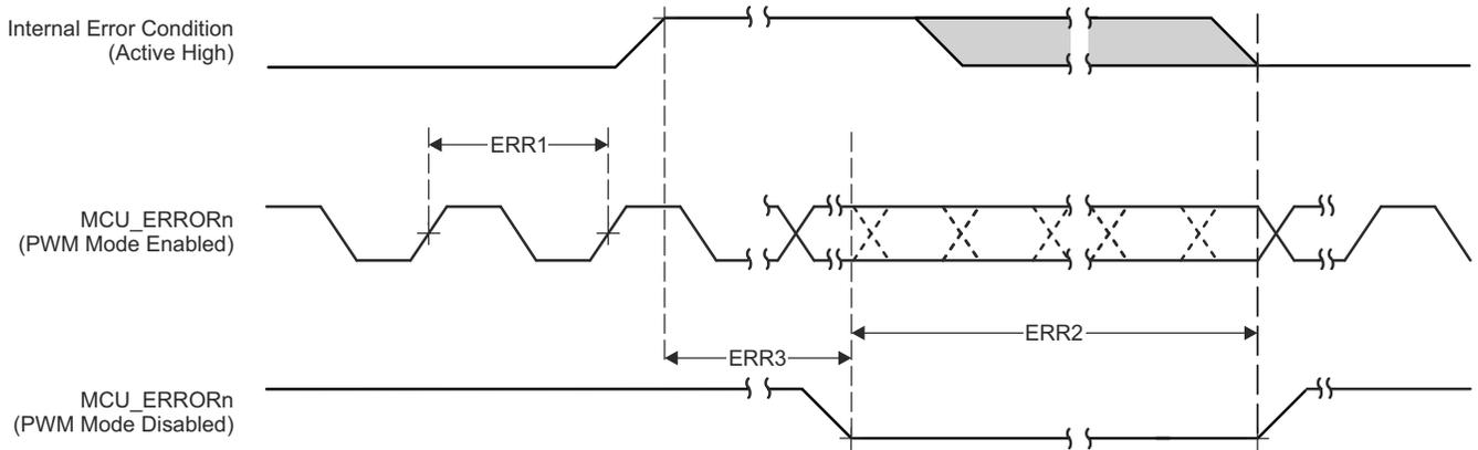
图 6-10. MCU\_ERRORn 时序要求和开关特性
