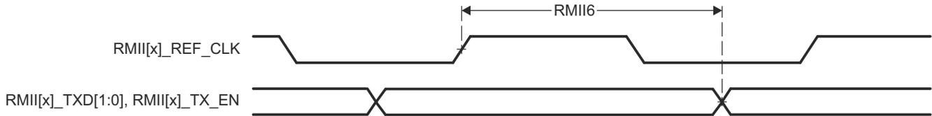
图 6-26. RMII[x]\_TXD[1:0] 和 RMII[x]\_TX\_EN 开关特性 - RMII 模式
