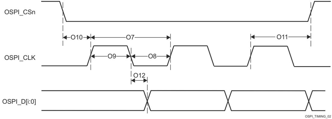
图 6-64. OSPI0 开关特性 - Tap SDR, 无环回
