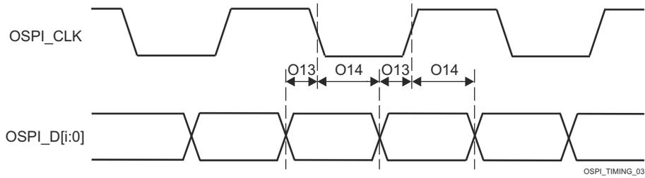
图 6-65. OSPI0 时序要求 - Tap DDR，无环回
