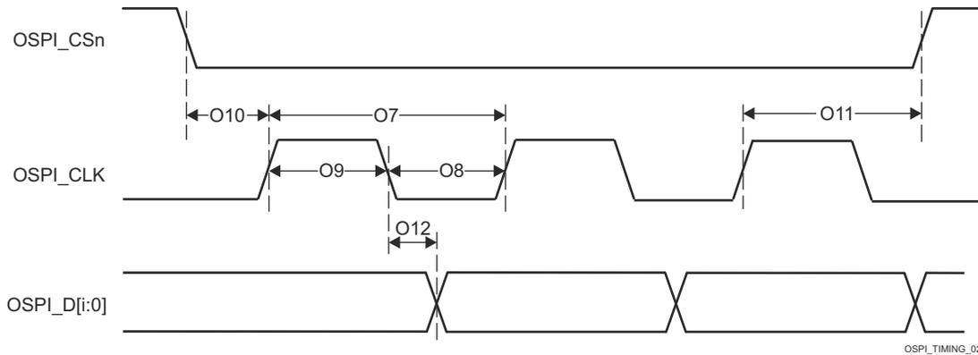
图 6-57. OSPI0 开关特性 - PHY SDR 数据训练
