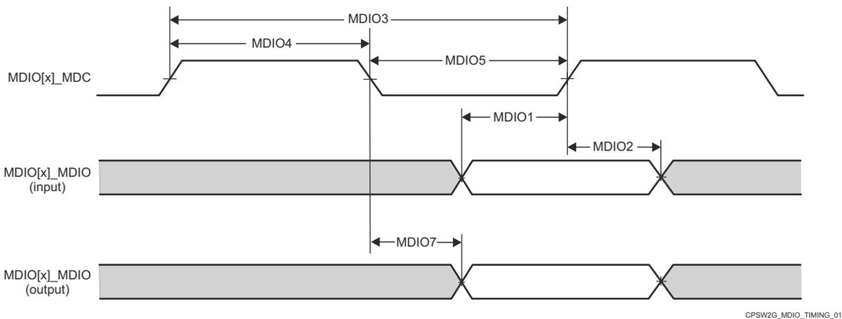
图 6-23. CPSW3G MDIO 时序要求和开关特性
