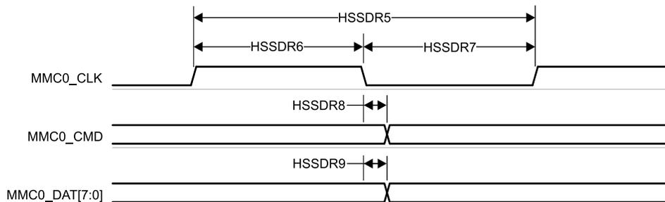
图 6-46. MMC0 - 高速 SDR 模式 - 发送模式
