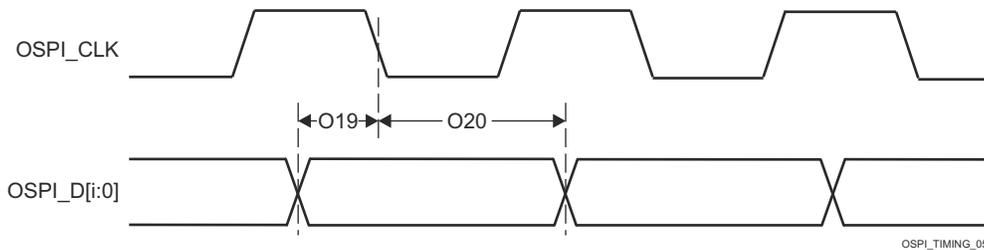
图 6-63. OSPI0 时序要求 - Tap SDR, 无环回
