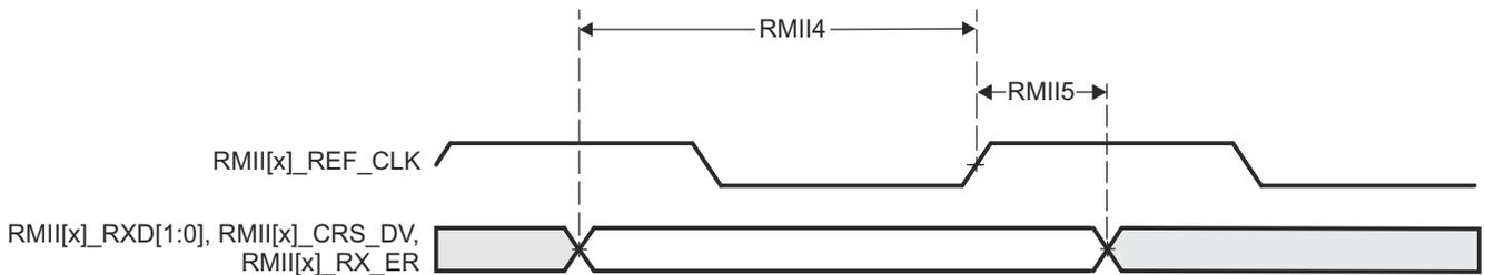
图 6-25. CPSW3G RMII[x]\_RXD[1:0]、RMII[x]\_CRS\_DV、RMII[x]\_RX\_ER 时序要求 - RMII 模式
