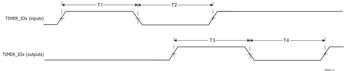
图 6-67. 计时器时序要求和开关特性
