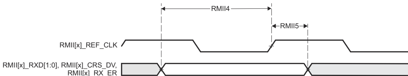
图 6-22. CPSW3G RMII[x]_RXD[1:0]、RMII[x]_CRS_DV、RMII[x]_RX_ER 时序要求 - RMII 模式
